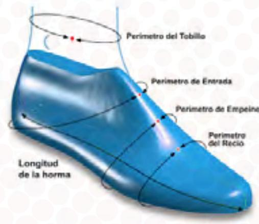
Figura 30: Partes de una horma para zapato bajo
