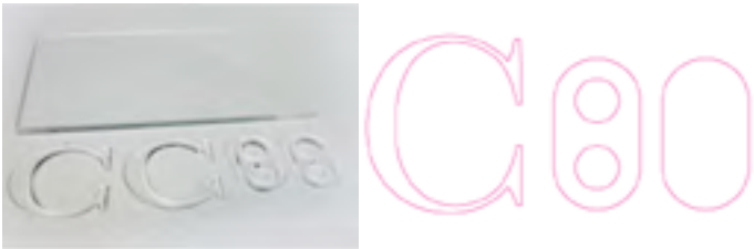
Figura 225. PMMA cortado a láser y patrones de corte. Fuente: El autor, (2018).
