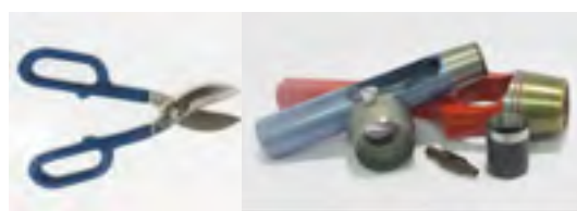
Figura 156. Tijeras para cortar metal y sacabocados. Fuente: El autor, (2018).
