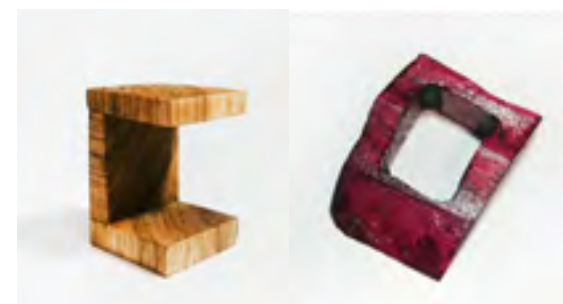
Figura 193. Pieza de madera encerada y pieza de madera tinturada y barnizada. Fuente: El autor, (2018).
