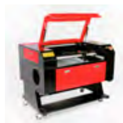
Figura 164. Cortadora a láser. Recuperado de: Vevor, (2017).
