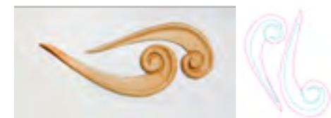
Figura 252. MDF tallada con fresadora CNC. Fuente: El autor, (2018).
