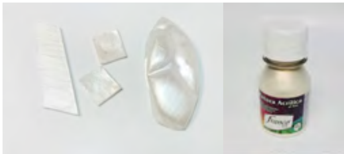
Figura 228. PMMA, PEAD y PET pintados con resina acrílica. Fuente: El autor, (2018).
