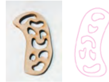
Figura 251. MDF cortada a láser. Fuente: El autor, (2018).
