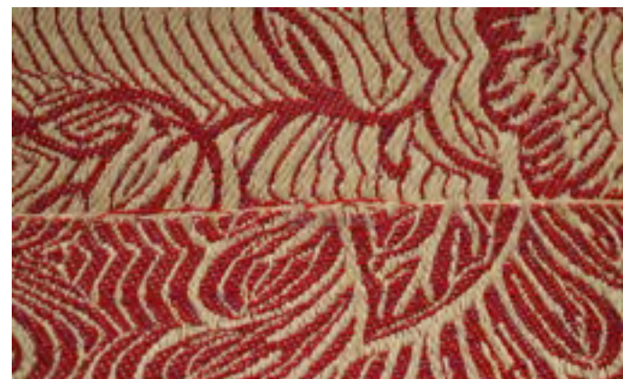
Figura 33. Tejido Jacquard, en la parte inferior se observa el anverso de la tela, y en la superior, el reverso. Recuperado de: González, (2014).
