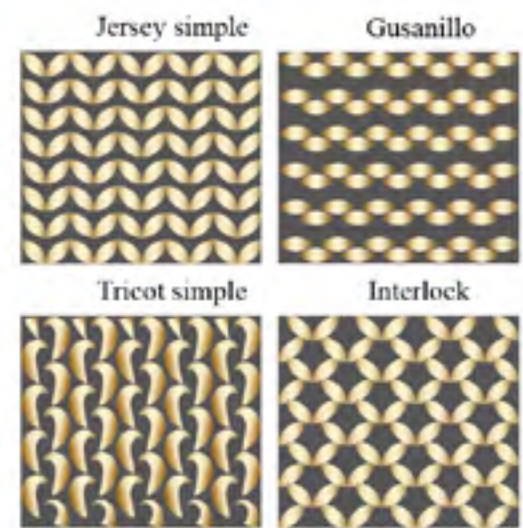
Figura 51. Esquema gráfico de las estructuras simples básicas del tejido de punto. Fuente: El autor, (2018).
