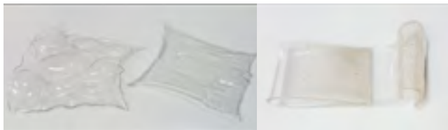
Figura 227. PET y PMMA termo-moldeados. Fuente: El autor, (2018).
