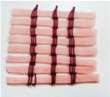
Figura 255. Inserción con método de enlace por medio de ondas. Fuente: El autor, (2018).
