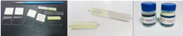
Figura 221. Piezas de vidrio cortadas y esmaltadas, piezas montadas listas para ser quemadas y esmaltes para vitro-fusión. Fuente: El autor, (2018).
