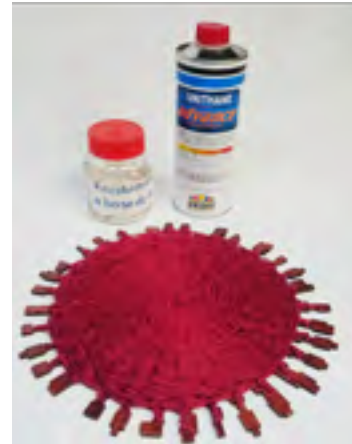
Figura 314. Tejido bañado con una solución a base de resinas. Fuente: El autor, (2018).
