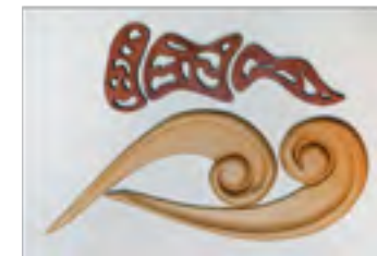
Figura 253. MDF tinturado, pulido y abrillantado. Fuente: El autor, (2018).
