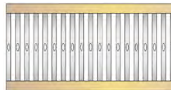
Figura 43. Sistema de lizos. Fuente: El autor, (2018).
