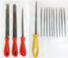
Figura 181. Limas para madera y limas para metal. Fuente: El autor, (2018).
