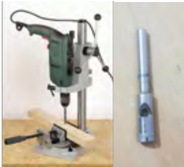
Figura 218. Banco para taladro y broca para vidrio. Fuente: El autor, (2018).
