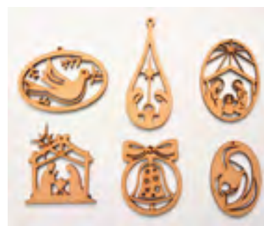
Figura 148. MDF cortado a láser. Recuperado de: Samaniego, (2017).
