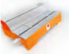
Figura 175. Mesa dobladora de acrílico a base de níquelina. Fuente: El autor, (2018).
