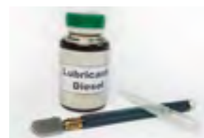
Figura 157. Cortador de vidrio de auto lubricado, lubricante y gotero. Fuente: El autor, (2018).
