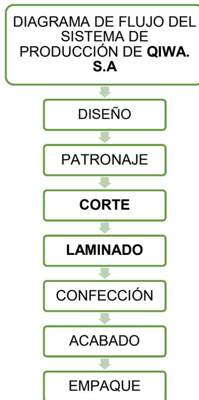
**Ilustración N° 17:** Diagrama de flujo de producción de QIWA S.A.
