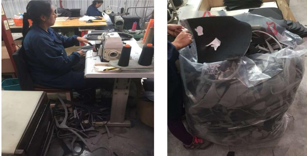
**Ilustración N° 22:** Residuos de vinil y espuma generados en el proceso de corte
