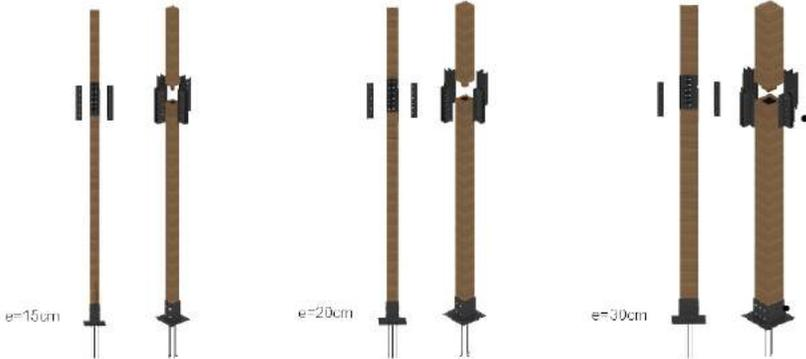
Columnas ensambladas en espiga y unidas con platinas metálicas, el espesor de las columnas van cambiando según la altura de los diferentes edificios
