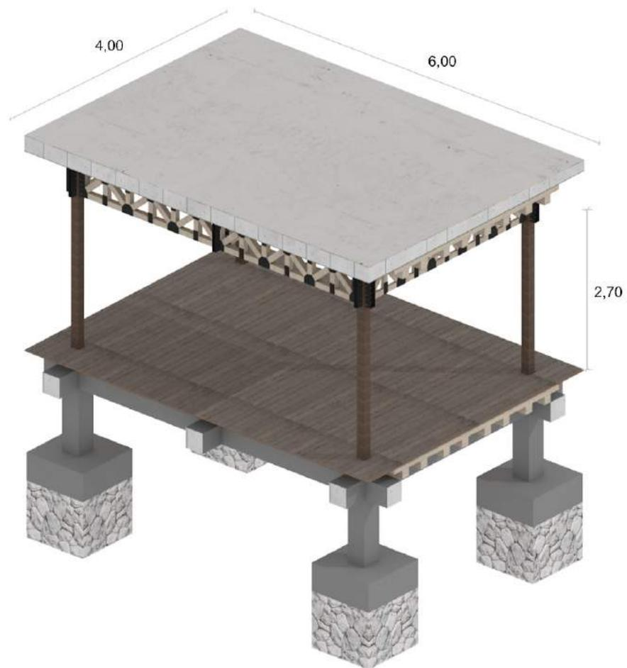
Los principales materiales aplicados en el proyecto fue el uso de la madera y los bloques de tierra compactada (BTC), los mismos que brindan un sistema sustentable para el medio ambiente y en la construcción, porque se reutiliza la tierra del lugar que se excavó para las cimentaciones en los BTC, resultando así la reutilización del material, además de ser un sistema prefabricado en la construcción al hacer uso de la madera.
