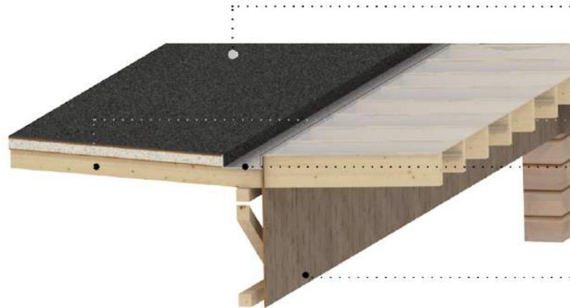
Compuesto de cubierta desde arriba hacia abajo (Membrana impermeabilizante e=5mm, planchas de eternit planas e=10mm, membrana aislante 75mm, eternit planas e=10mm)
