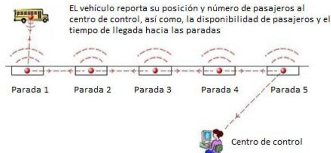
**Figura 3.12 Horario de buses inteligentes basado en ZigBee**
