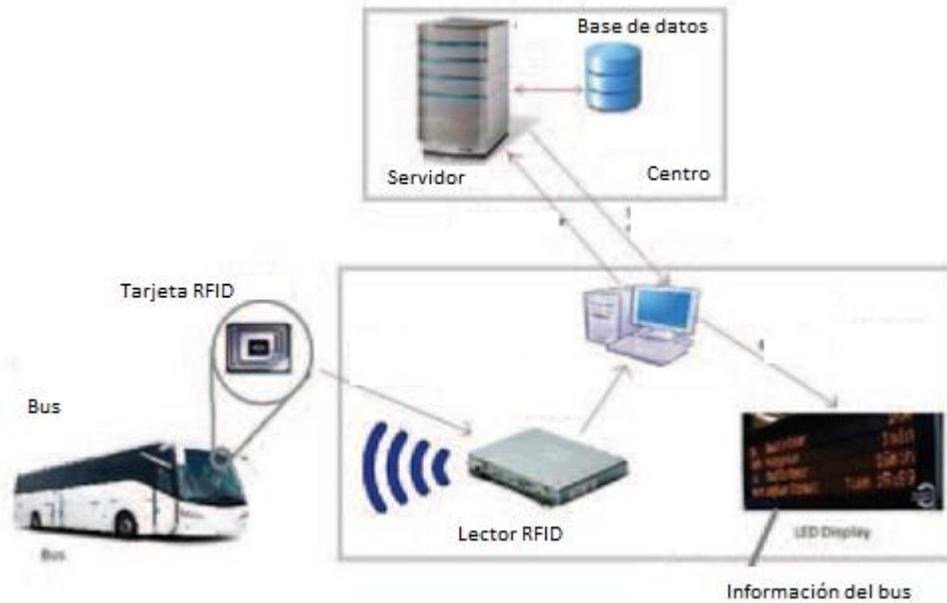
**Figura 3.7 Un sistema para localización y seguimiento de buses y su visualización mediante RFID**
