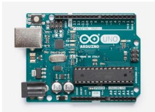
**Figura 4.4** Tarjeta ARDUINO UNO
