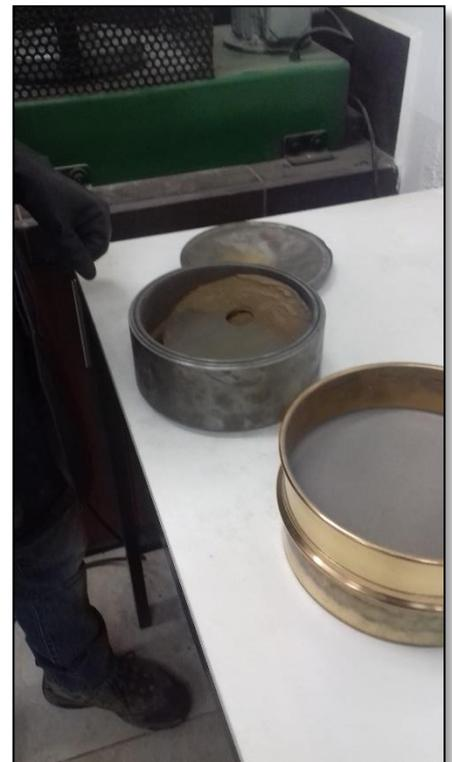
Figura 2.2. Secado, triturado y tamizado de la muestra.
