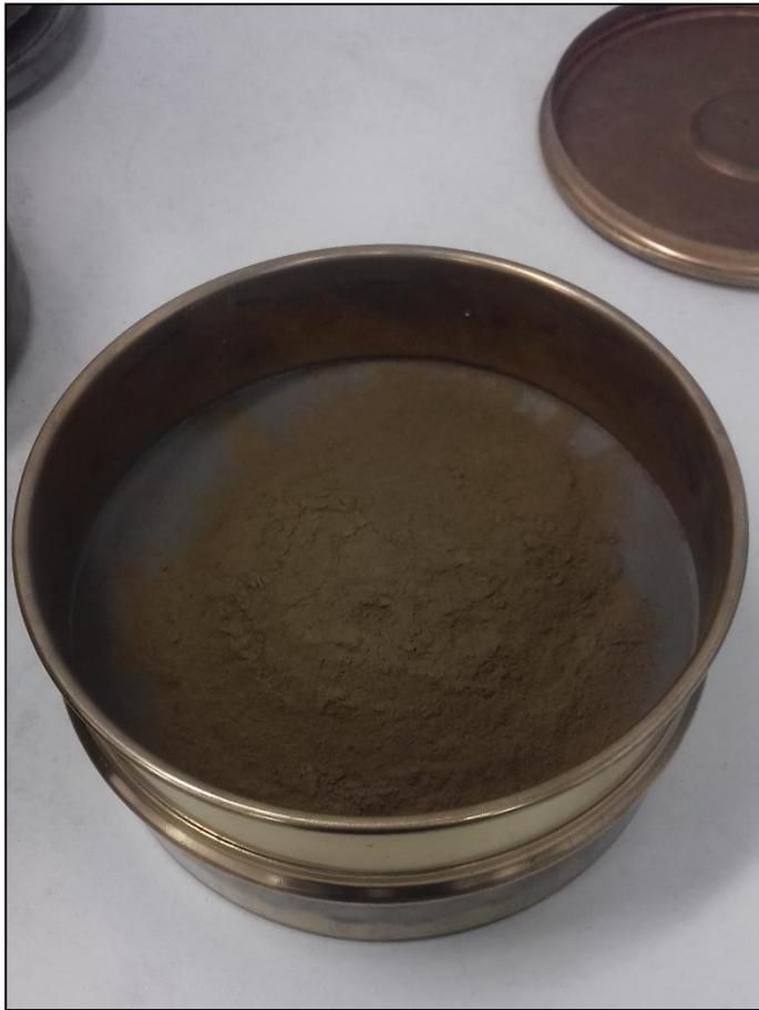
Tamizado de la muestra hasta tener un tamaño menor de 75  $\mu\text{m}$  y obtener 30 gr aproximadamente.
