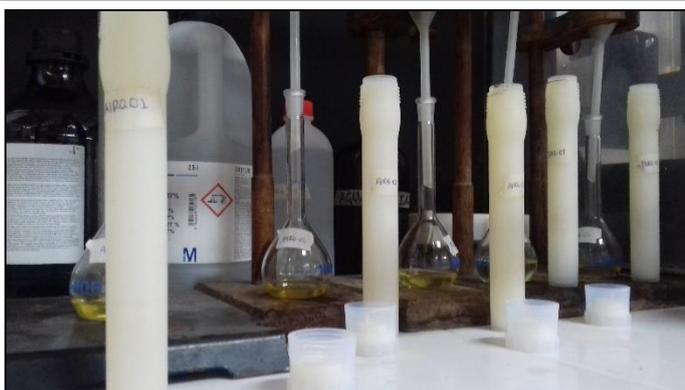
Filtrado de la solución y aforado a 100 ml con agua destilada.
