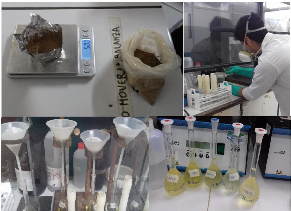
Figura 2.3. Pesado, digestión con ácido nítrico, filtrado y aforado de la muestra.
