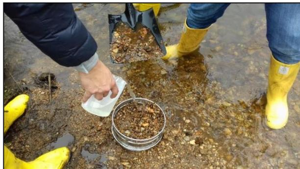
Figura 2.1. Tamizado de sedimentos fluviales.
