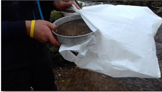
Colocación de sedimentos en una funda plástica para su transporte.
