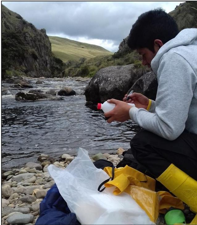
Etiquetado de la muestra con el código correspondiente, coordenadas y fecha del muestreo.
