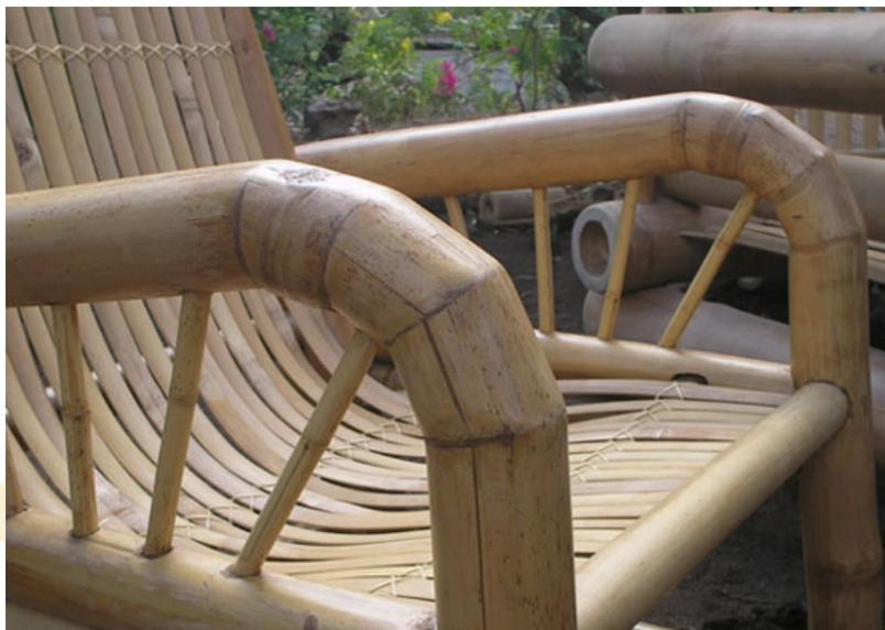
Ilustración 012 Resultados de Curvado mediante cortes en apoyabrazos.
