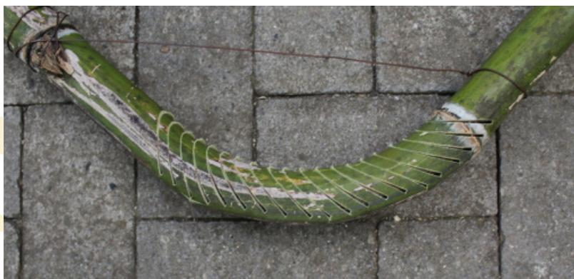
Ilustración 3—016 Detalle del corte a 45
