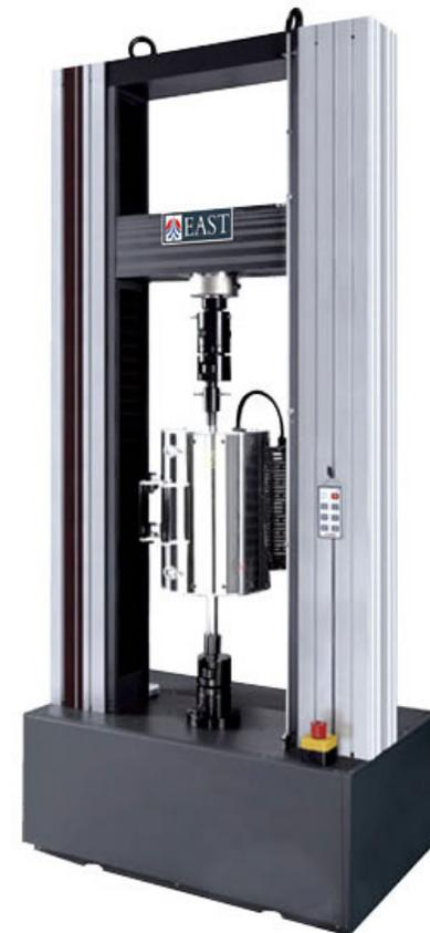
Ilustración 07 Prensa para medición a la compresión paralela a la fibra.
