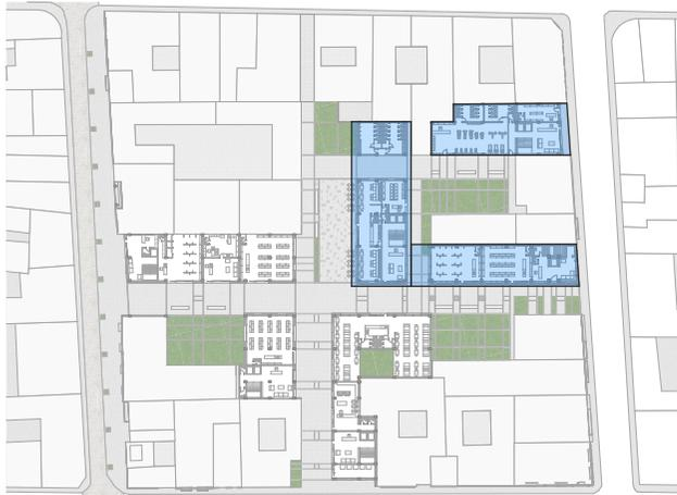
Los bloques D - E - F, forman entre si la forma de una U, conformando de esta manera un espacio verde central, el cual es comunicado con el resto del proyecto por las circulaciones, que atraviesan en planta baja los distintos bloques de edificaciones.
