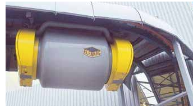
Imagen 24. vertidor de hormigón
