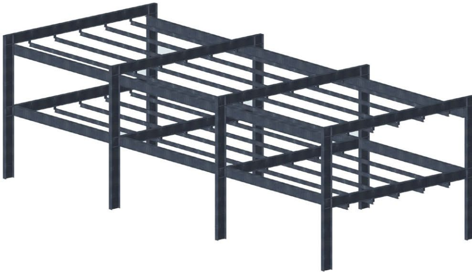
Estructura metálica aporticada
