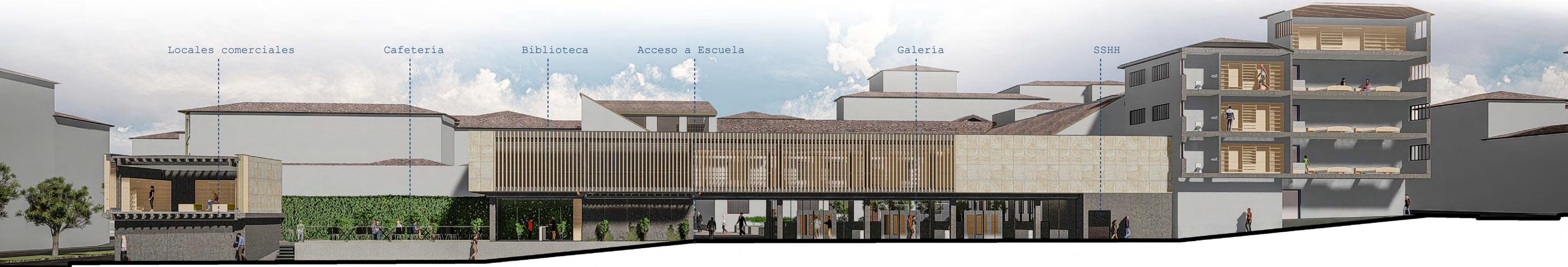
El gráfico muestra la diferencia de alturas que se genera en la manzana, para resolver este problema, en el interior del predio se aterrazó en dos planos conectados a través cómodas pampas accesibles con pendientes menores al 8%.
