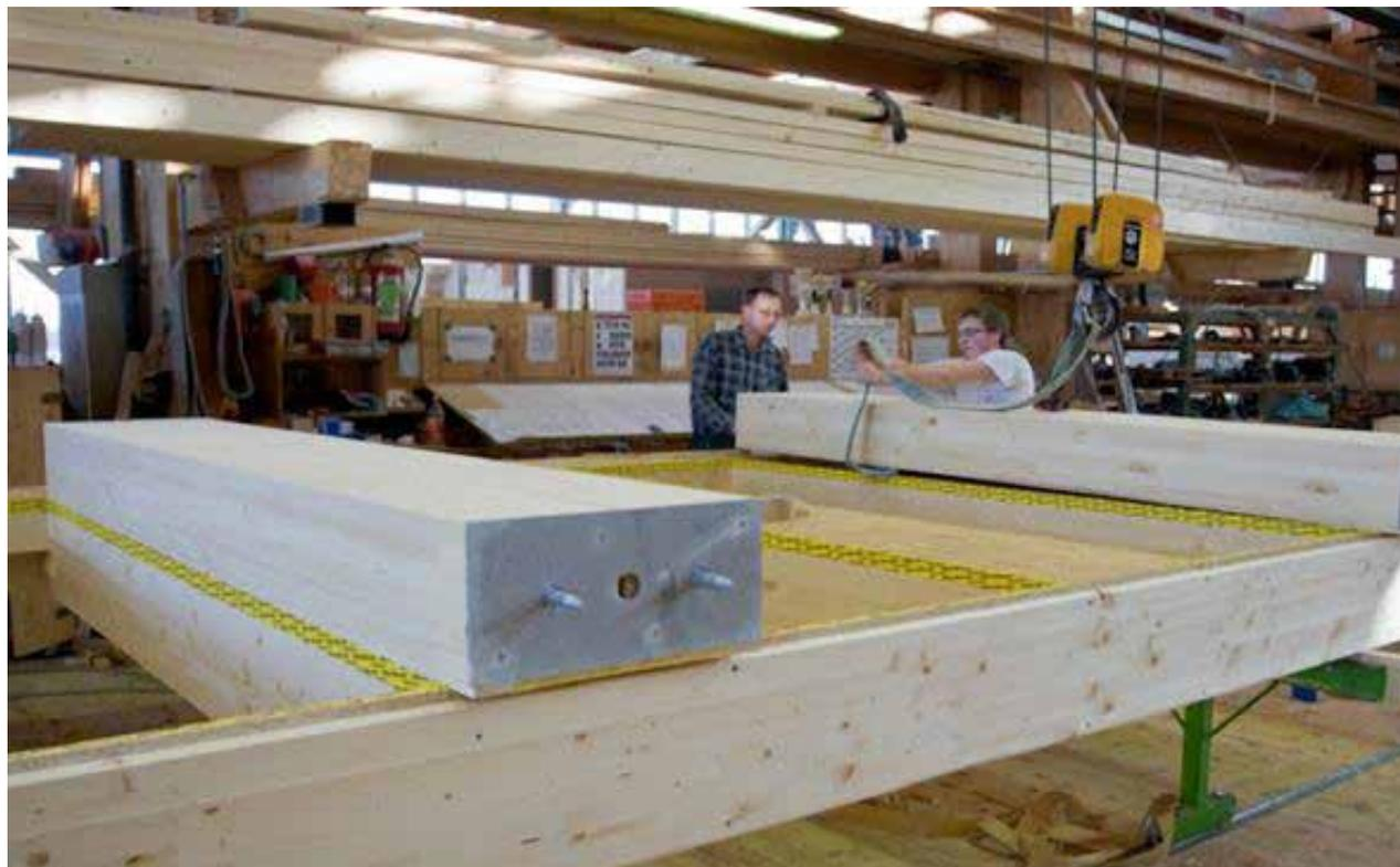
imagen 30 armado de paneles de fachada en fábrica previo a ser transportado
