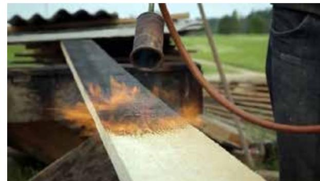
Imagen 5 .impermeabilización de madera por Carbonizado de
