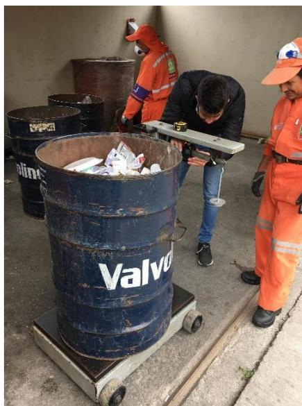
Figura 3.1.14. Pesaje de tanque con desechos.
