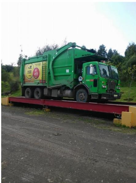
Figura 3.1.4. Pesaje de vehículo recolector de carga frontal con desechos sólidos.
