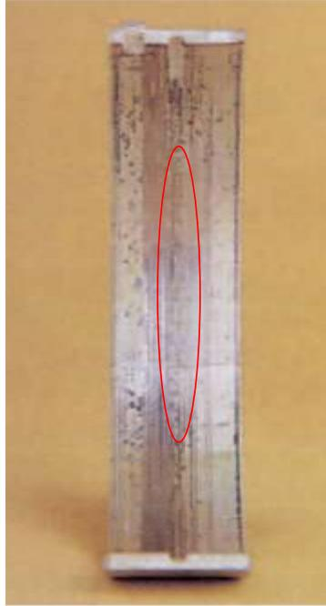
*Fig.1.12.- Desgaste abrasivo*
