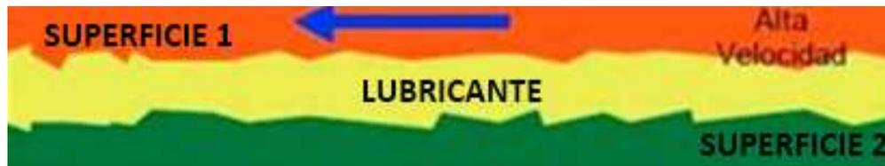
*Fig.1.3.- Lubricación Hidrodinámica*
