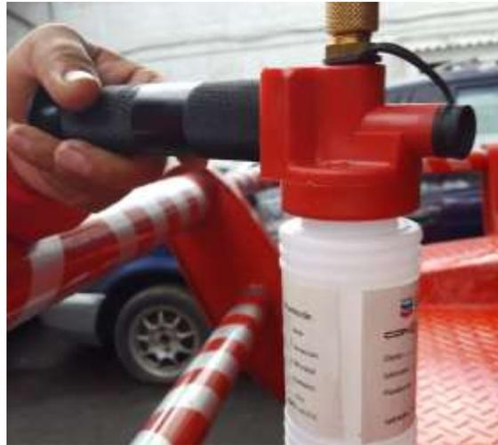
*Fig. 3.8.- Bomba de vacío y envase para la recolección de muestra de aceite
