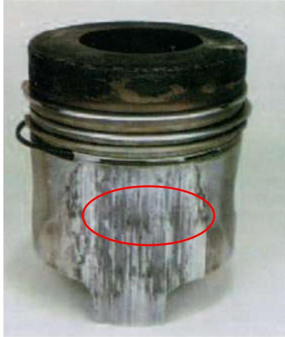
*Fig.1.9.- Desgaste adhesivo o por contacto metal-metal
