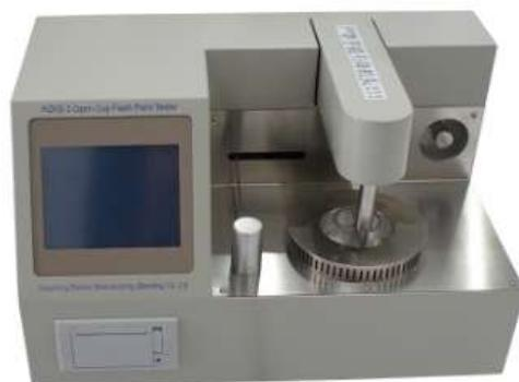
*Fig.2. 2.- Equipo para determinar el punto de inflamación por vaso cerrado
