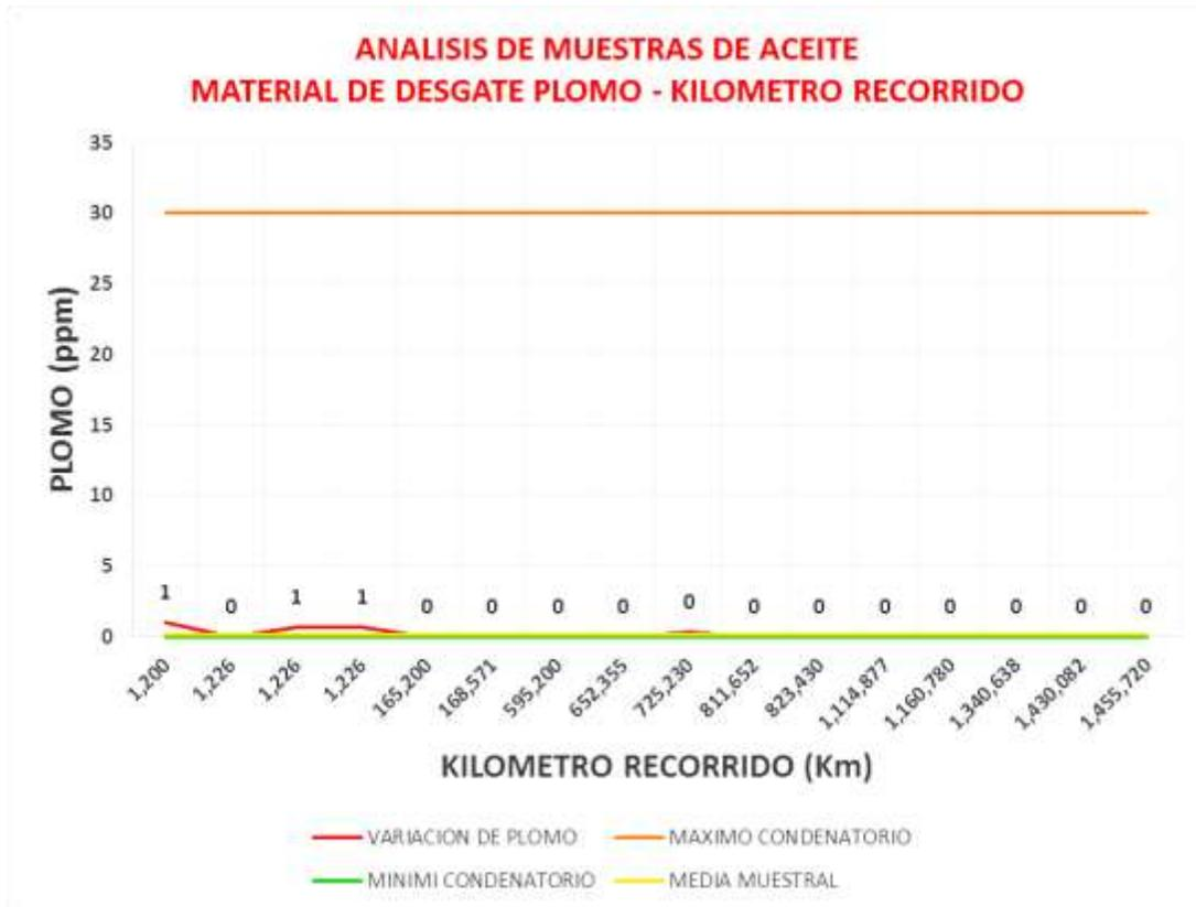
*Fig.4.8.- Comportamiento del material de desgaste del Plomo
