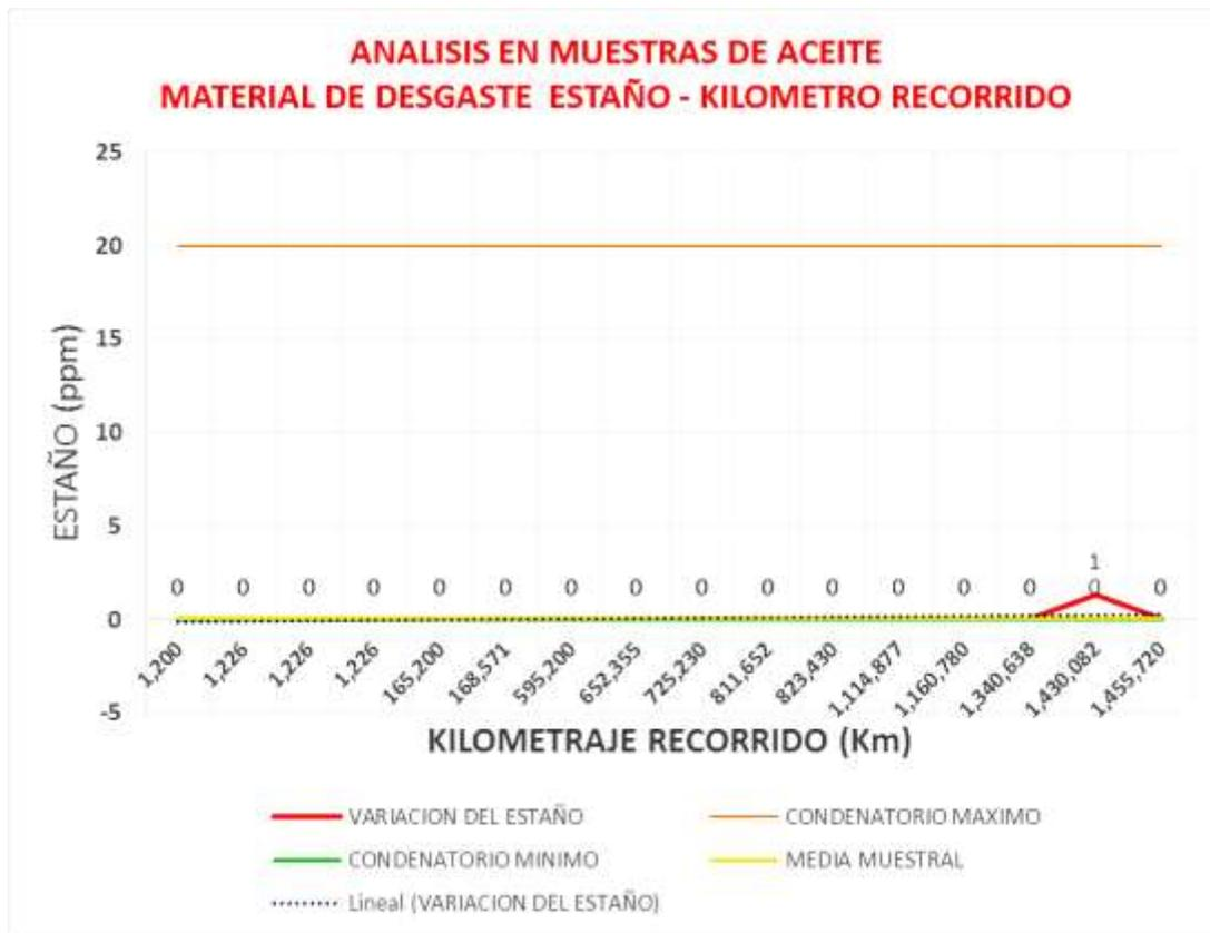
**Fig.4.6.- Comportamiento del material de desgaste del Estaño**
