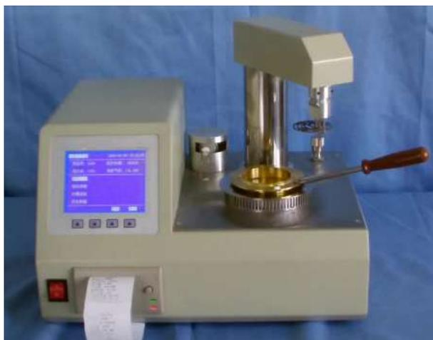
***Fig.2. 1 Equipo para determinar el punto de inflamación por vaso abierto
