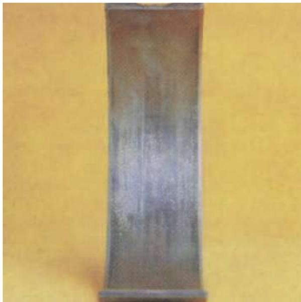
***Fig.2. 10.- Desgaste corrosivo en los cojinetes
