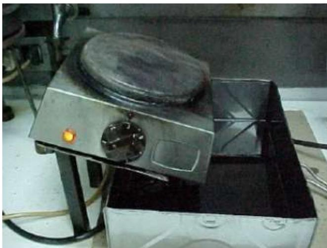
**Fig.2. 5.- Determinación de la presencia de agua en el aceite por crepitación**
