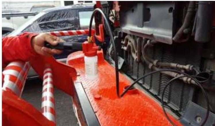
***Fig. 3.10.- Bomba de vacío con el envase para tomar la muestra
