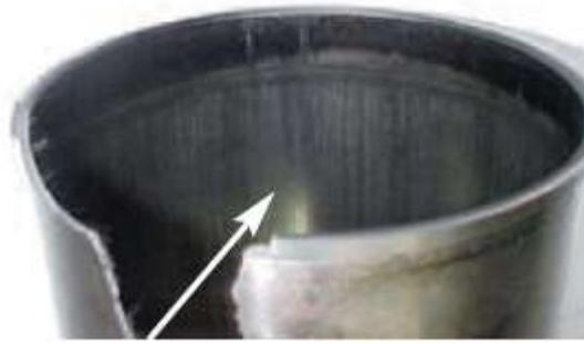
***Fig.2. 8.- Desgaste generado por los segmentos del pistón en la camisa***
