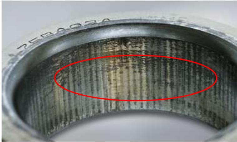
***Fig.1.10.- Desgaste por fatiga superficial***
