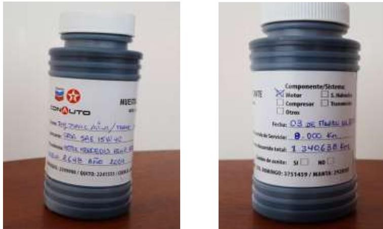
**Fig. 3.112.- Muestra de aceite usado y etiquetado para ser enviado al laboratorio**
