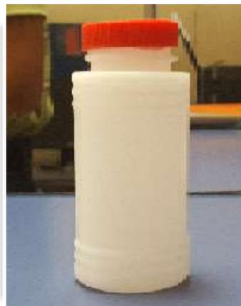
**Fig. 3.7.- Etiquetas y envase para la recolección de muestra de aceite usado**
