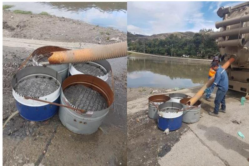
Figura 1.9. Descarga en los cilindros para muestreos.
