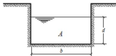
Figura 2.24. Sección rectangular del canal transportador.
