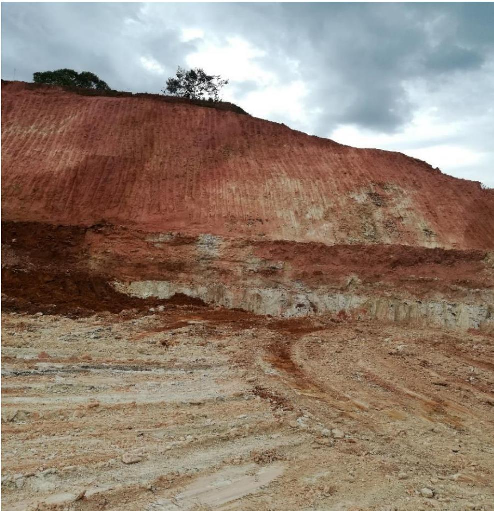
Figura 1.15: Sobrecarga en el frente de explotación
