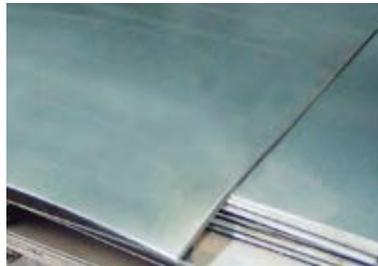
Figura 2.25: Lámina de acero galvanizado.
