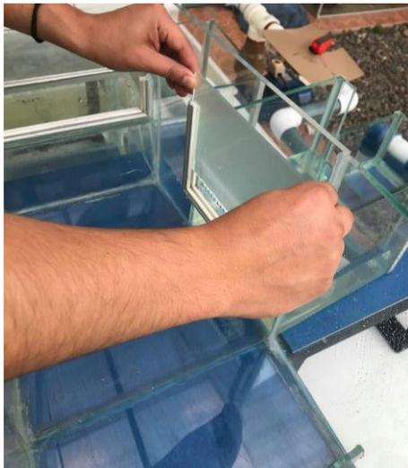
Figura 3.7: Cierre de la compuerta lateral.
