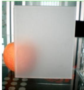
Figura 2.20: Vidrio claro ácido de 4 mm.
