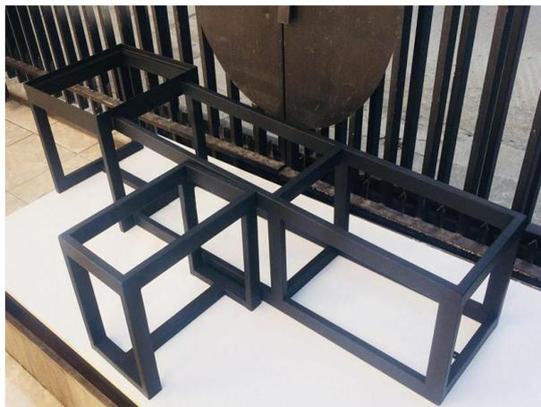
Figura 2.32: Soporte metálico con 3% de pendiente.
