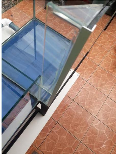
Figura 2.35: Acople de perfiles tipo ángulo.
