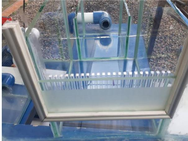
Figura 2.37: Compuerta para la rejilla lateral.
