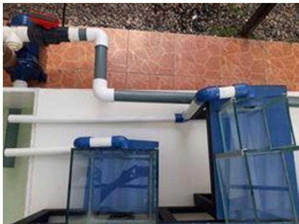
Figura 2.38: Tubería de desfogue para las dos captaciones.
