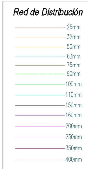
Figura 1.7: Simbología de tuberías de distribución de agua potable.
