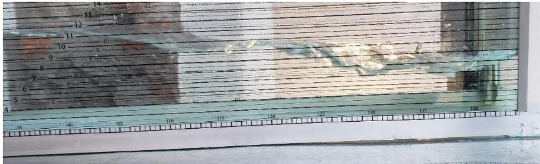
Figura 3.19 Resalto hidráulico sumergido en la compuerta
