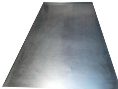
Figura 2.26 Plancha de metal galvanizado
