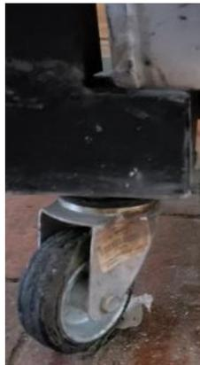
Figura 2.54 Rueda en la base de un tubo estructural (Columna)
