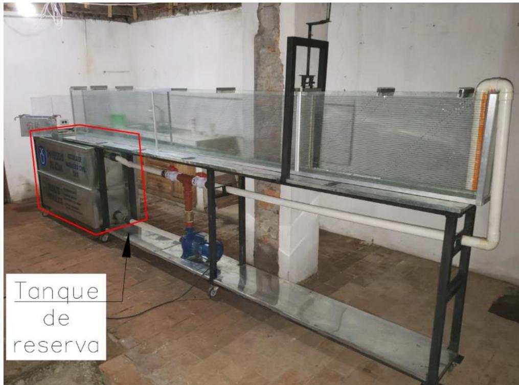
Figura 2.20 Tanque de reserva del modelo
