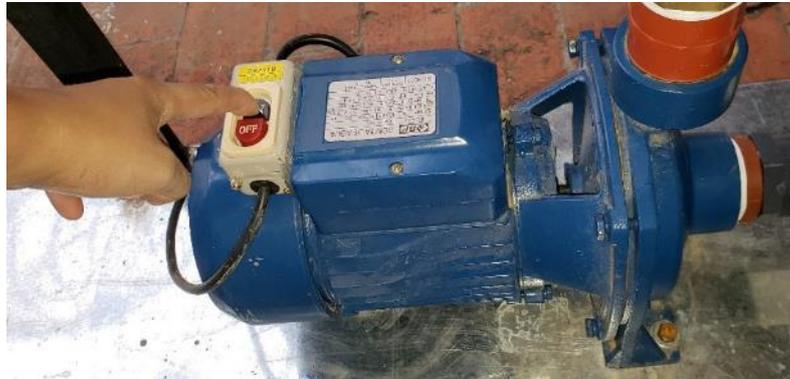
Figura 3.13 Encendido del interruptor de bomba centrífuga
