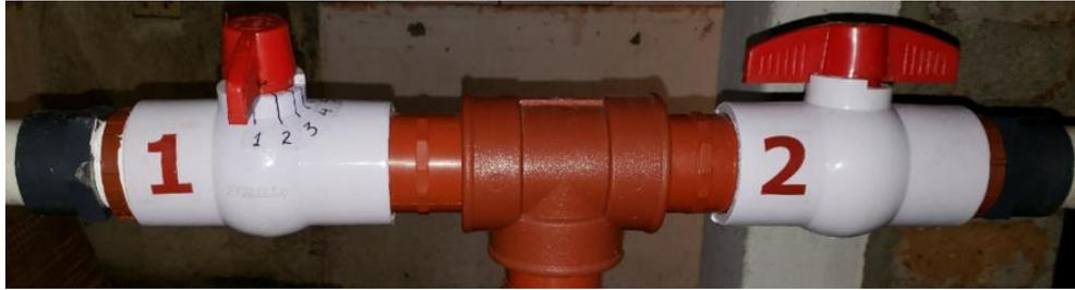
Figura 2.47 Válvula 1 cerrada (regulable) y válvula 2 abierta (fija)
