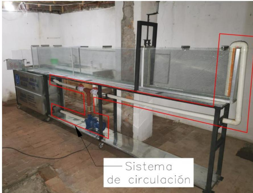
Figura 2.28 Sistema de circulación del agua del modelo
