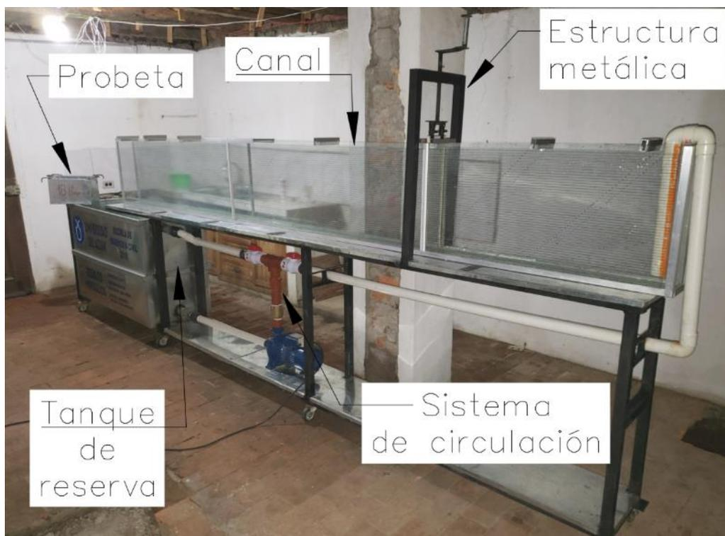
Figura 2.1 Modelo físico con sus partes más importantes
