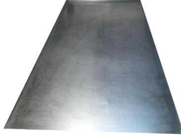
Figura 2.49 Plancha de metal galvanizado
