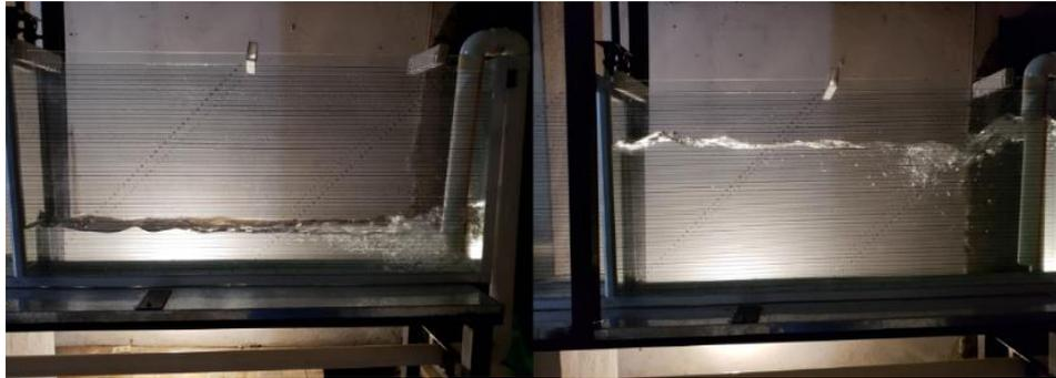
Figura 3.15 Altura de columna de agua estable antes de compuerta
