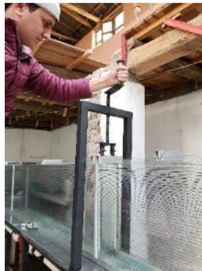
Figura 3.11 Regulación de altura de compuerta estabilizadora de caudal
