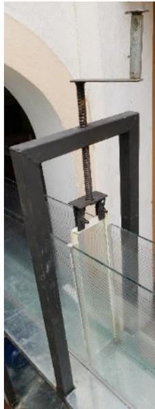
Figura 2.55 Mecanismo de apertura de la compuerta de paso
