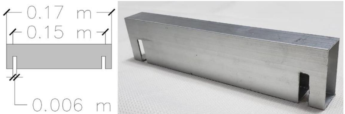
Figura 2.19 Diseño y modelo físico de los soportes de aluminio
