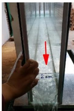
Figura 3.17 Colocación del obstáculo de menor medida al final del canal
