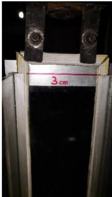
Figura 2.16 Indicación de apertura de 3 cm en la compuerta
