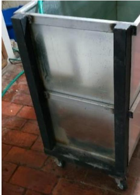
Figura 2.52 Tubos estructurales del esqueleto del modelo físico
