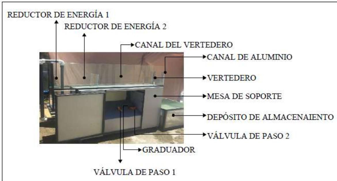
**Figura 3.2** Partes del modelo físico
