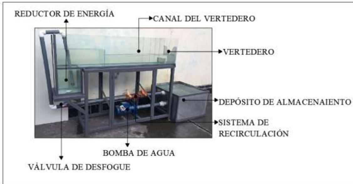
**Figura 1:** Esquema general del modelo físico
