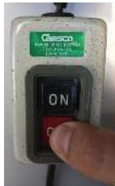
**Figura 3.21** Apagado de la bomba
