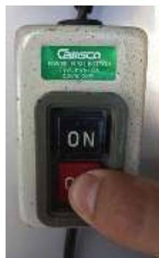
**Figura 3.63** Apagado de la bomba
