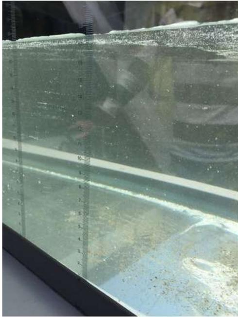
**Figura 7:** Reglas para la medición de la carga hidráulica
