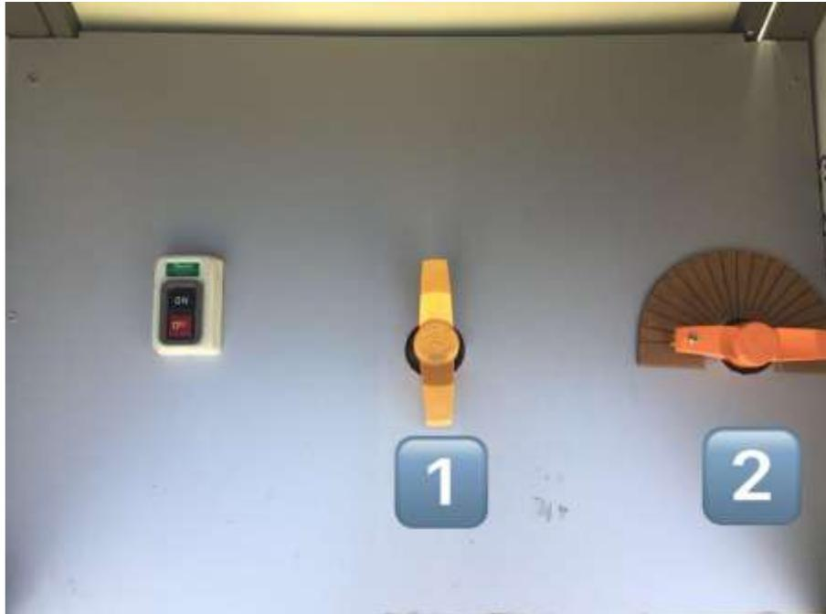
**Figura 2:** Control de encendido y apagado de la bomba y válvulas reguladoras de caudal
