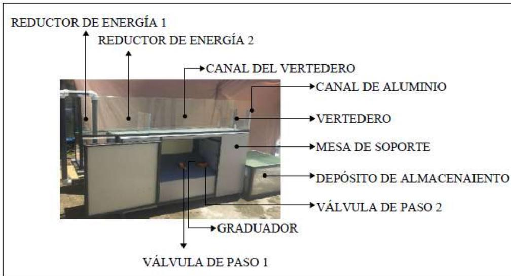
**Figura 3.23** Partes del modelo físico
