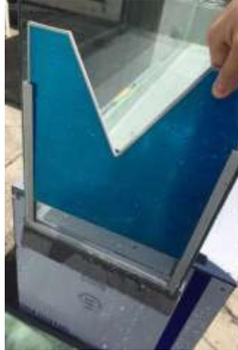
**Figura 3.46** Ranura para colocar el vertedero triangular
