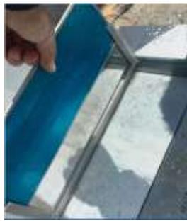
**Figura 3.4** Ranura para colocar el vertedero rectangular sin contracciones laterales
