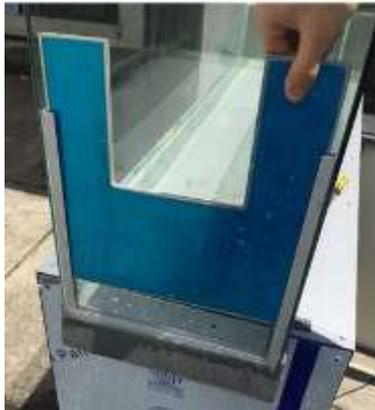
**Figura 3.25** Ranura para colocar el vertedero rectangular con contracciones laterales
