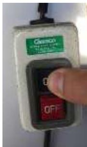
**Figura 3.59** Encendido de la bomba
