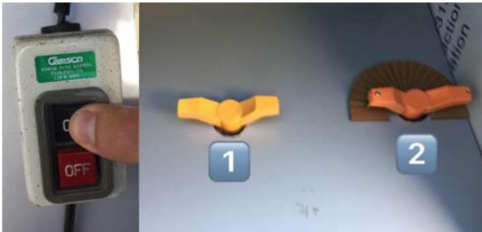
**Figura 3.13** Encendido de la bomba, con las válvulas de paso abiertas
