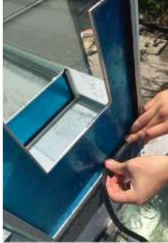
**Figura 3.26** Colocación de la tira de caucho
