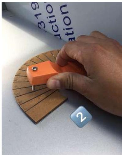
**Figura 3.57** Cerrado de la válvula de paso, utilizando el graduador
