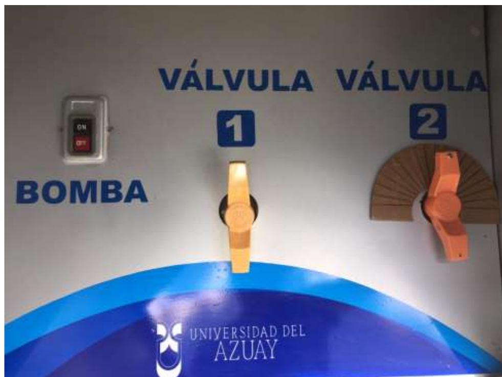
**Figura 12:** Válvulas reguladoras de caudal y control de la bomba
