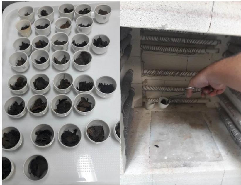
Figura 3.- Proceso de calcinación de alícuota de las muestras
