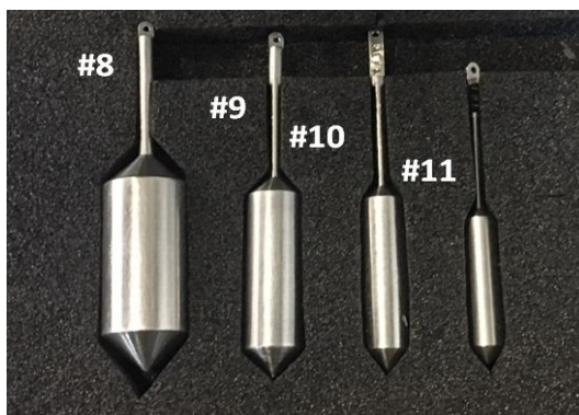
Figura 1.2. Spindles, cuyo tamaño es usado dependiendo del tipo de muestra a analizarse.
