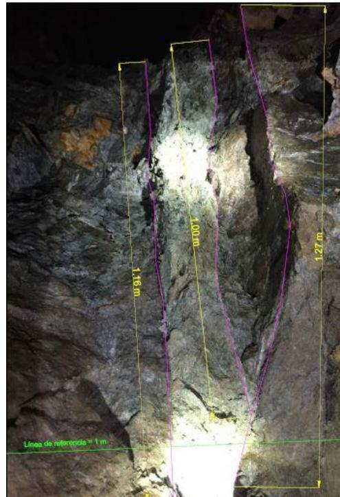
Figura 2.3 Determinación de la continuidad de discontinuidades.
