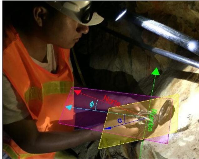
Figura 2.1 Determinación de la orientación de discontinuidades.
