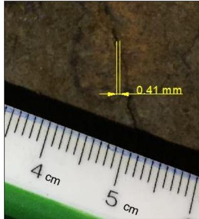
Figura 2.4 Determinación de la abertura de discontinuidades.
