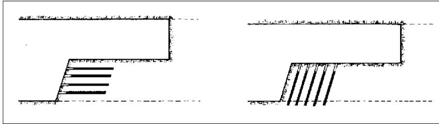
Figura 4.26. Banqueo horizontal y vertical en un avance a doble sección.
