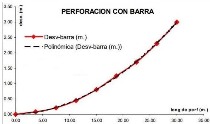
Figura 4.18. Curva de desviación de perforación con barra.
