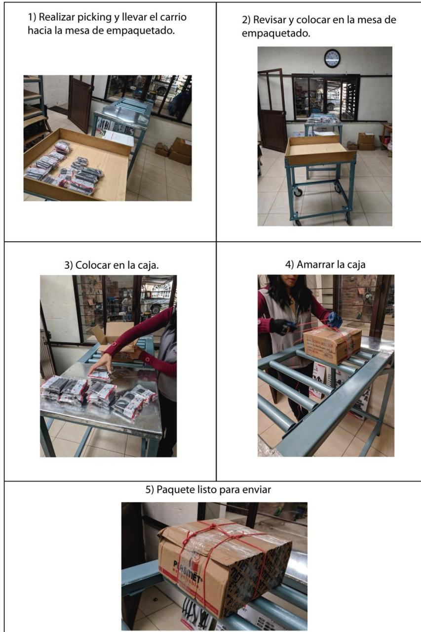
Figura 20 Funcionamiento mesa de empaquetado
