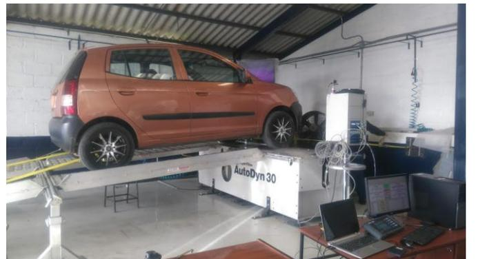
Figura 4. Prueba de laboratorio (ciclo de conducción HWFET).
