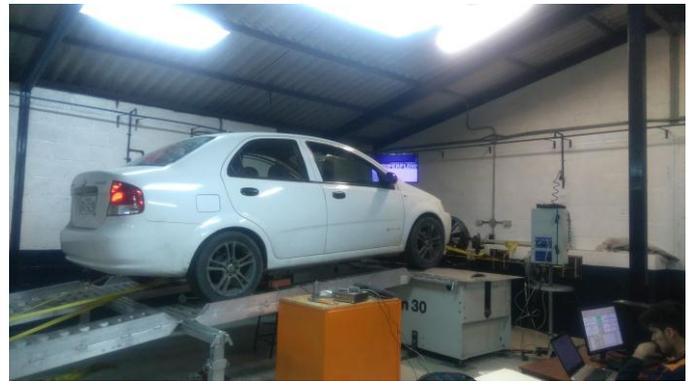
Figura 3. Prueba de laboratorio (Ciclo de conducción FTP75)
