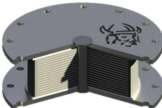
**Figura 2.16** Aislador con núcleo de plomo (LRB)
