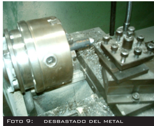
FOTO 9: DESBASTADO DEL METAL
