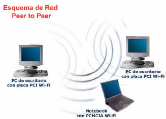
Figura 1.4 Red en configuración Peer to Peer
