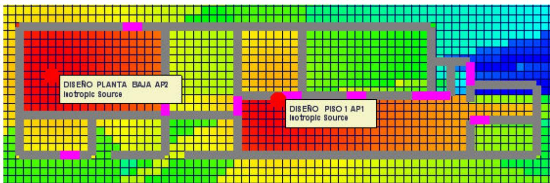
**Ubicación de Access Point y Plano en DISEÑO Planta Baja**
