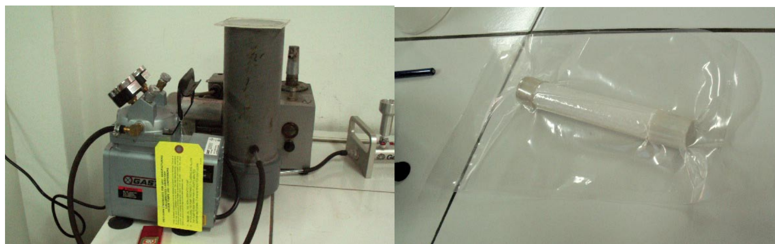
FOTO # 33 / 34 / 35 MATERIALES PARA TRATAMIENTO POR SUSTRACCIÓN DE OXIGENO, TRATAMIENTO POR TRANSFORMACION DE ATMOSFERAS, PROTOTIPO DE CAMARA AL VACIO.
