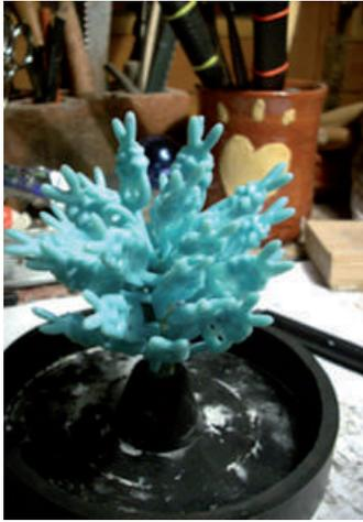
Después de realizado el árbol se lo pesa con la base de caucho para saber la cantidad de metal que se va a utilizar para la fundición. Luego se procede a preparar el yeso con agua caliente para poder verter en el cilindro donde se encuentra el árbol de cera con la base de caucho que no le permita salirse. Se lo introduce al cilindro con el yeso en la máquina de vacío donde se saca todo el aire de la mezcla con el agua para
