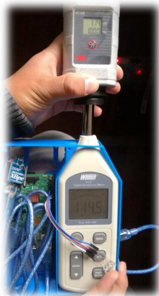
Forma de colocar el calibrado en el micrófono del sonómetro Wens.
