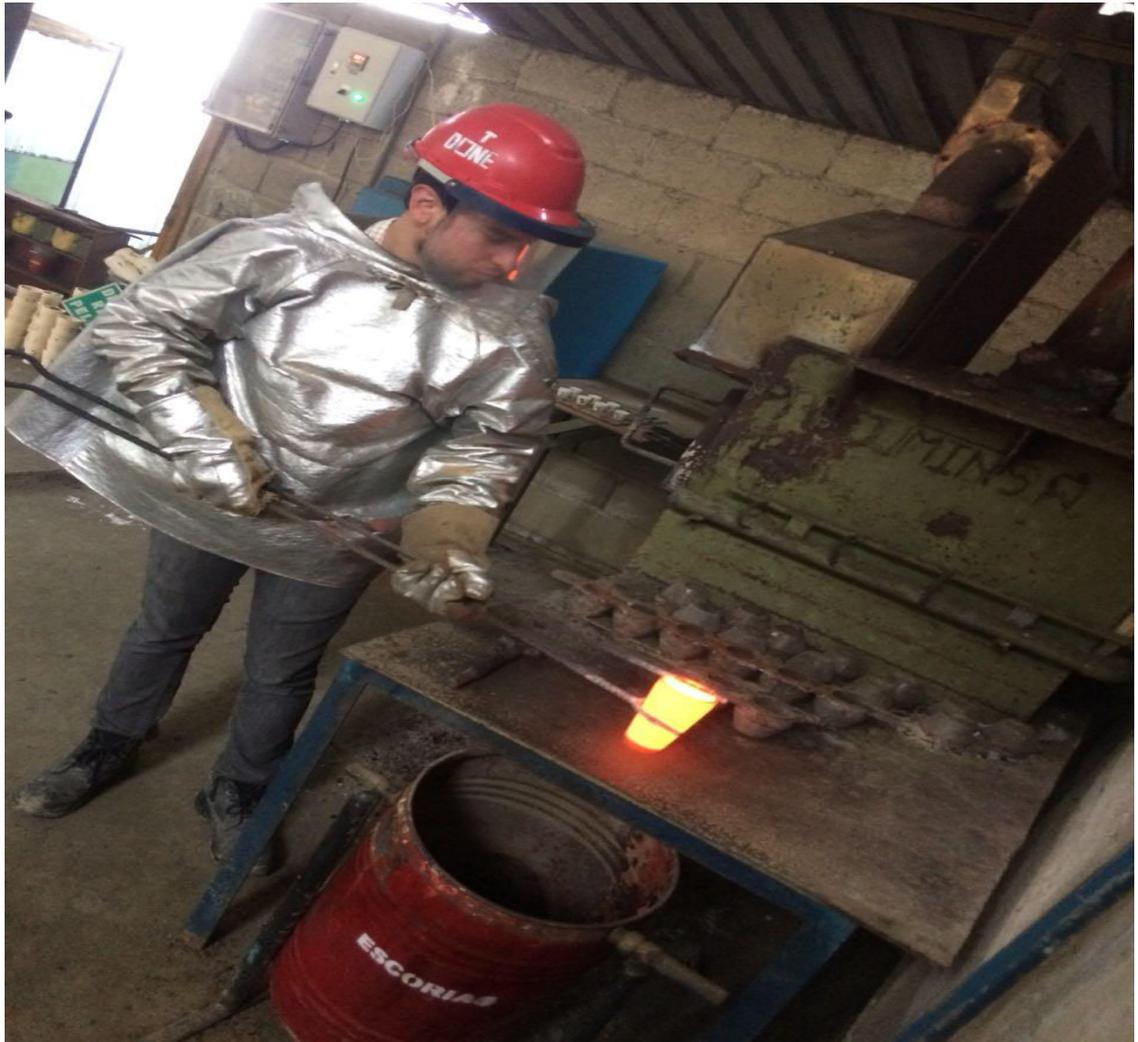
Figura 4.8. Extracción de la muestra del horno.
