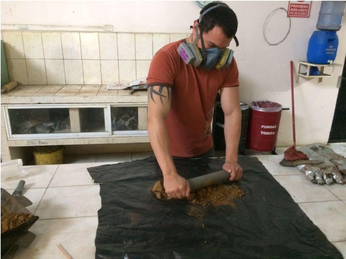
Figura 4.5. Homogenización de muestras.
