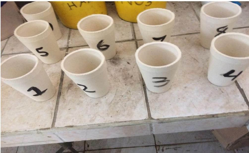
Figura 4.7. Preparación de la muestra en crisoles.
