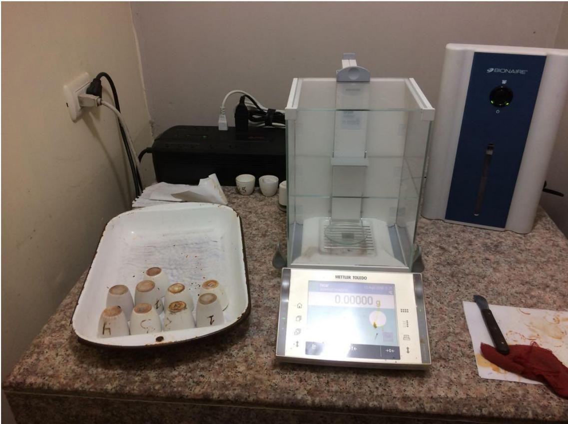
Figura 4.9. Pesado de la muestra en la balanza analítica.
