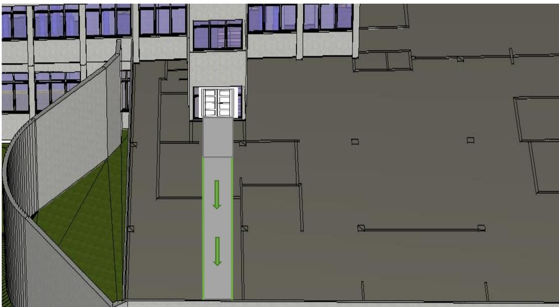
Figura 3. 13: Señalización de la ruta de evacuación hacia las gradas de emergencia
