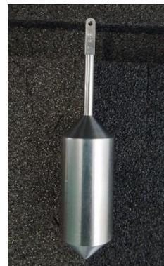
**Figura 13.** Spindle TR8.
