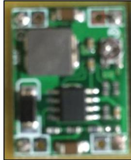
Figura 3.12 Regulador de Voltaje 3.3v
