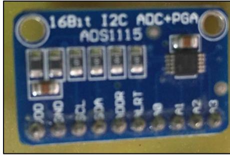
Figura 3.9 Convertidor Analógico Digital
