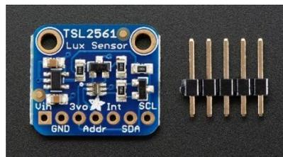
Figura 2.5: Sensor de luminosidad TSL2561
