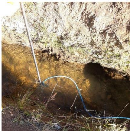
Figura 2.7 Medidor electromagnético valeport ajustado a la altura adecuada
