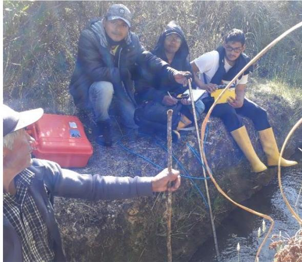
Figura 2.10 Momento en el que se realiza una medición de velocidad en el canal de captación.
