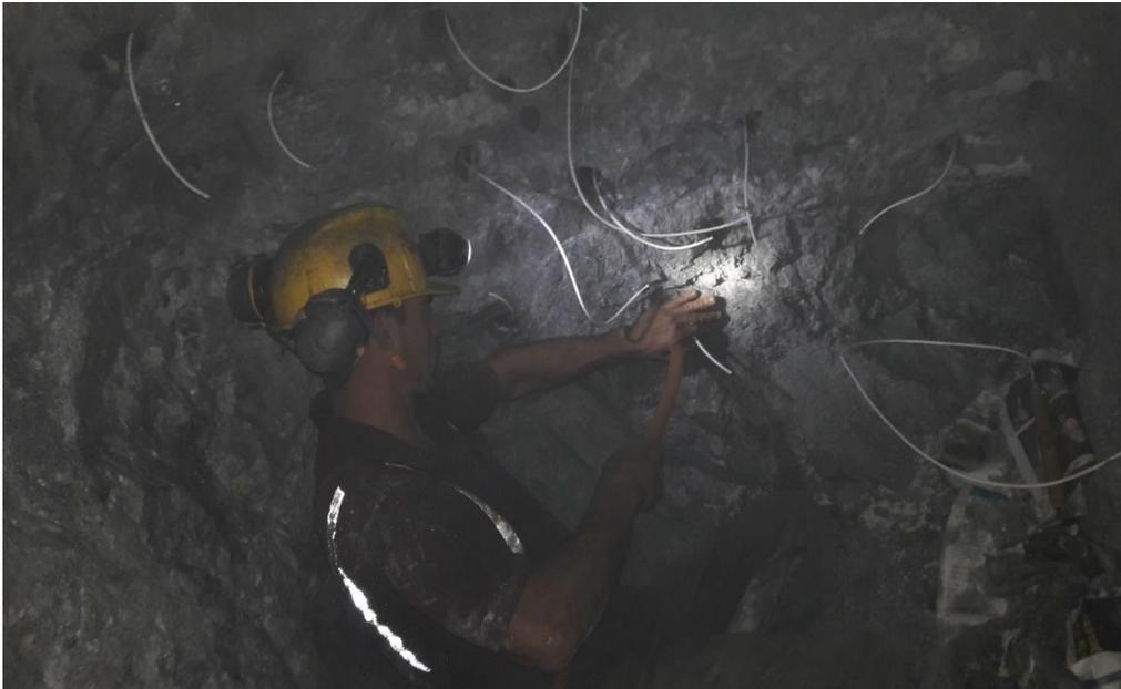
**Ilustración 4** Ayudante de Perforación (Ubicación de cargas Explosivas)
