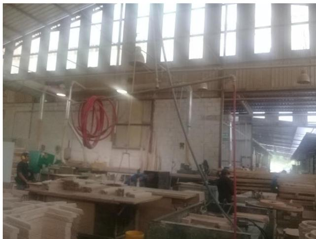
Figura 47: Mangueras para limpieza con aire comprimido (PROPIA, 2018)
