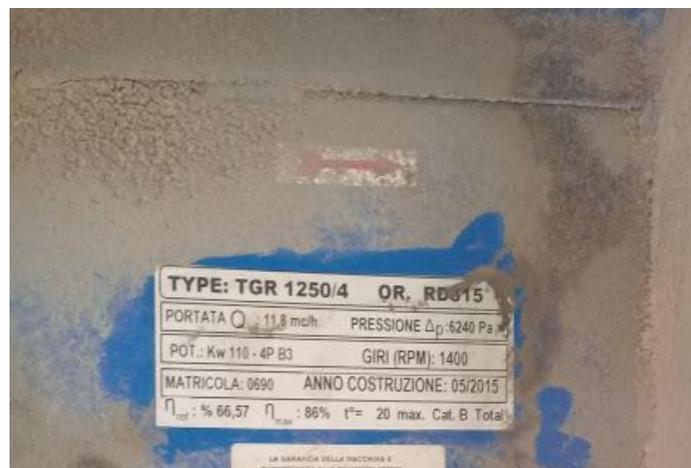
Figura 18: Placa de identificación del silo de recolección de viruta (COLINEAL, 2018)
