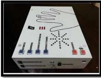
Figura 11. Dispositivo simulador de Braille con comunicación Bluetooth [18].
