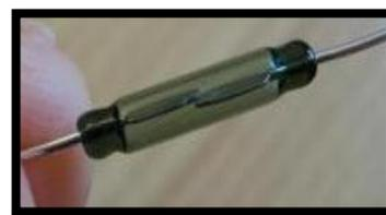
Figura 24. Interruptor magnético normalmente abierto (*Reed Switch*).
