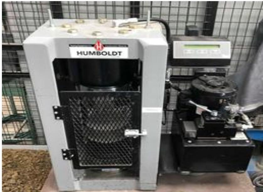
Figura 3. 4 Máquina de compresión Humboldt.
