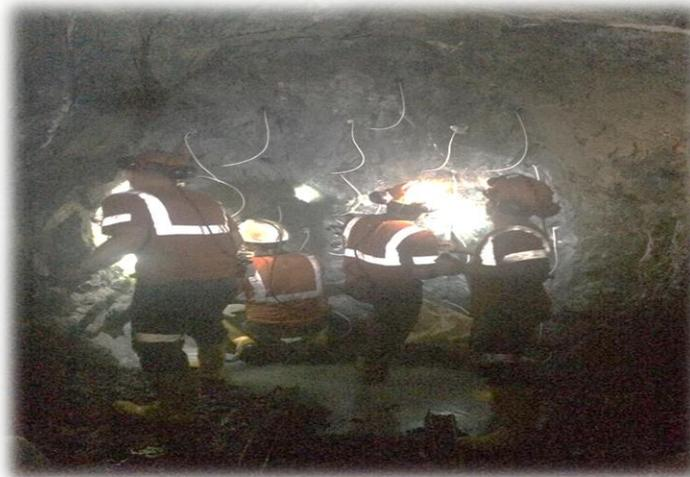
Figura 2.2 Trabajo de carga de explosivos
