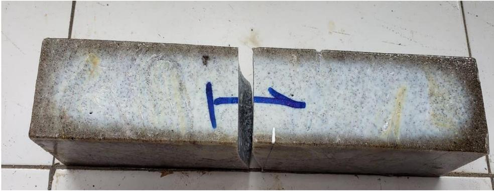
Figura 3.7 Muestra el tipo de fractura por flexión
