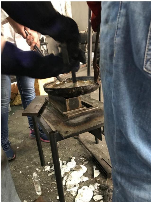
Anexo 4 Colocación de la mezcla en el molde
