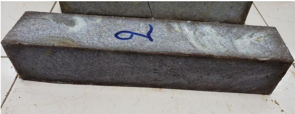
Figura 3.8 Muestra falla al esfuerzo máximo y sin fractura
