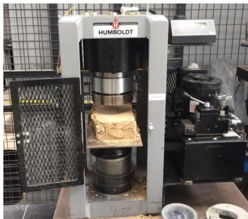
Figura 3.2 Prensa Humboldt con capacidad de carga de 50000 kg
