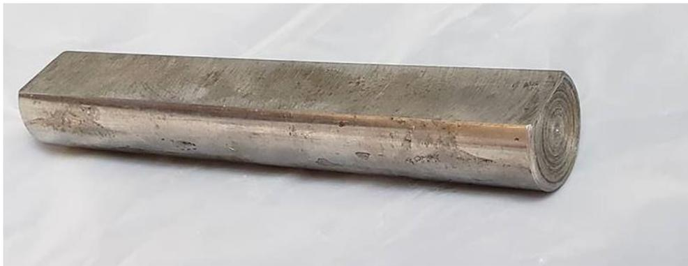
Figura 3.3 Cilindro de soporte para flexión
