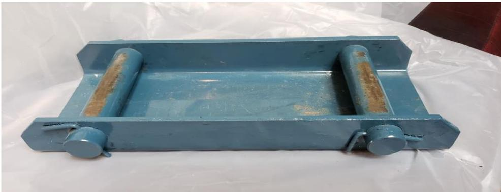
Figura 3.4 Soporte para prueba de flexión.
