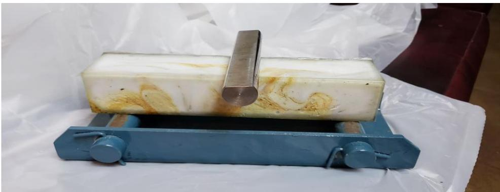
Figura 3.5 Soporte con muestra para realizar ensayo de flexión.
