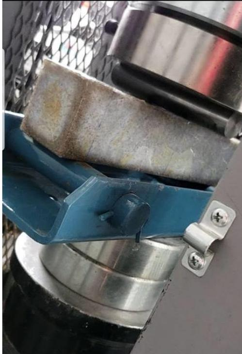
Figura 3.6 Soporte para prueba de flexión en prensa Humboldt
