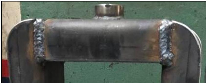
Figura 2.12: Soporte superior para puntas cónicas.
