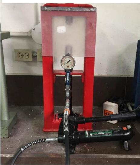
Anexo 8: Colocación de una probeta en la máquina a compresión.
