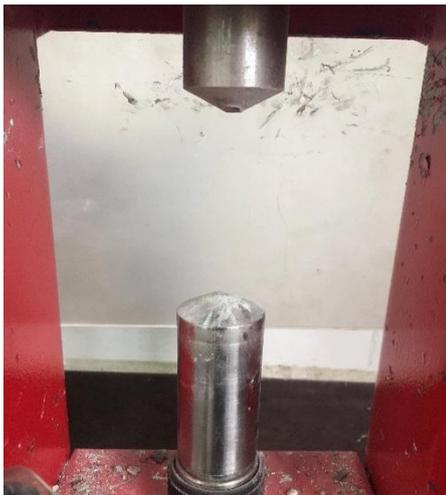
Anexo 16: Probetas de roca luego de la realización de pruebas en la máquina construida.
