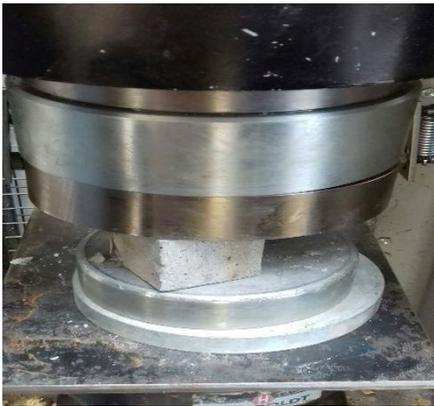
Anexo 10: Probetas ensayadas en la máquina a compresión.
