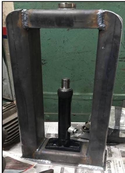
Figura 2.2: Base para el pistón hidráulico.
