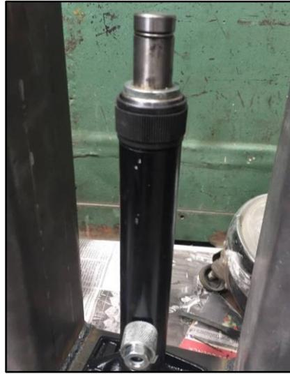
Figura 2.9: Pistón hidráulico.
