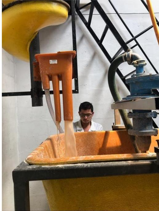
Figura 2. 9: Diferenciación de los tamaños presentes en la canaleta del espiral en la prueba realizada
