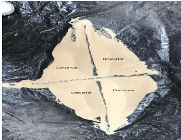
Figura 2. 5: Cuarteo de muestra con especificaciones.
