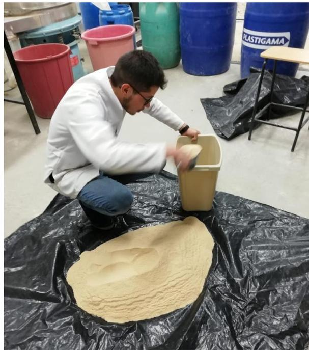
Figura 2. 1: Secado de material aluvial
