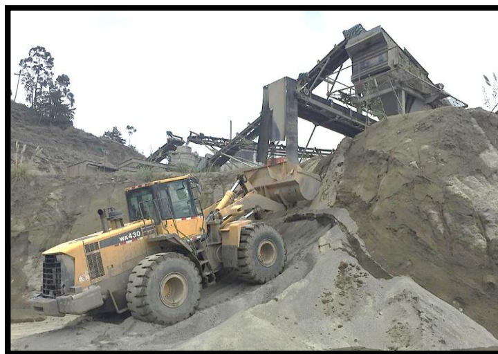
Figura 3.7: Recolección de arena de Tonalita con cargadora
