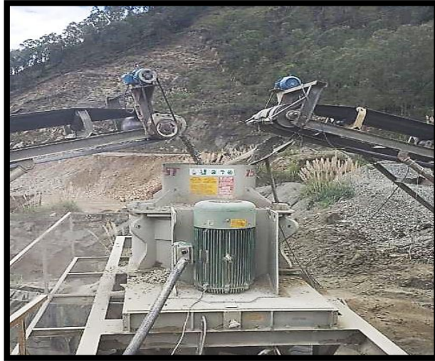
Figura 3.6: Trituradora de Impactos VSI
