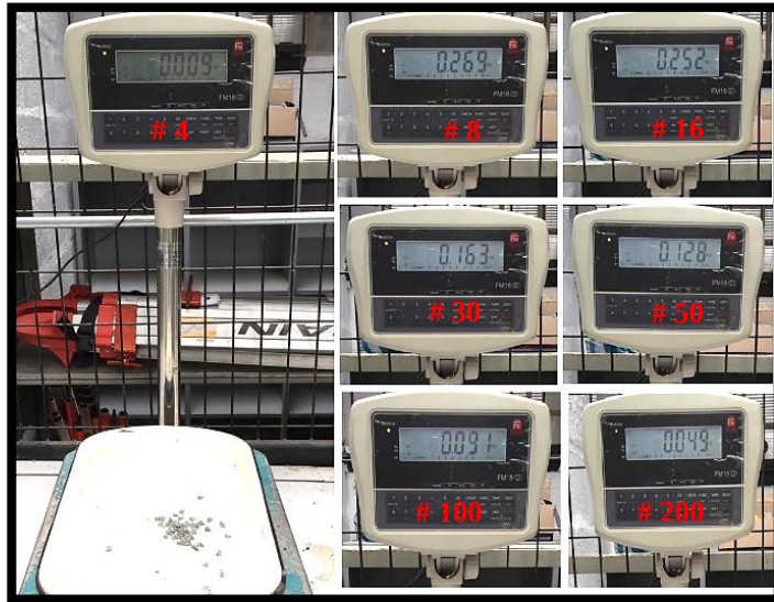
Figura 3.15: Pesos registrados del tamizado de Tonalita (cónica)
