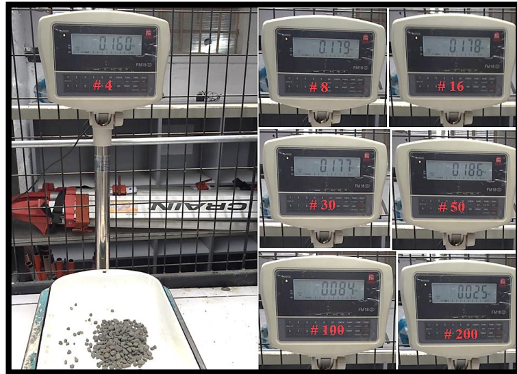
Figura 3.11: Pesos registrados del tamizado de arena de río
