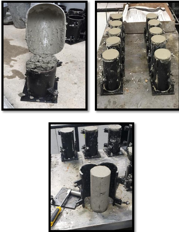
Figura 3.29: Fraguado y colocación de hormigón en moldes cilíndricos
