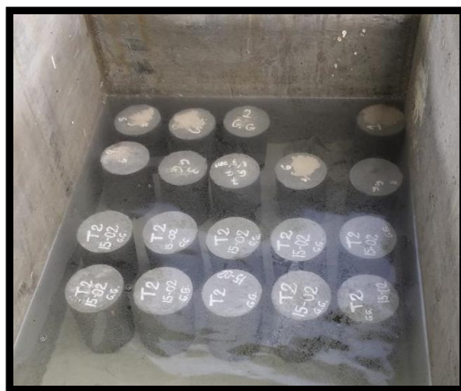
Figura 3.30: Curado de hormigón Tipo 1 y 2, sumergidos en agua
