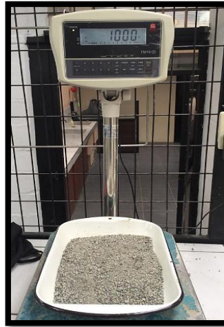
Figura 3. 17: Peso seco inicial de la muestra de Tonalita (impactos)
