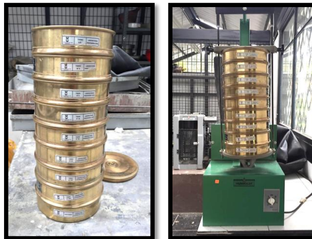
Figura 3.18: Tamices & Agitador mecánico
