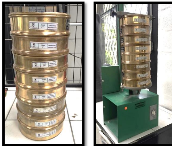
Figura 3.22: Tamices & Agitador mecánico
