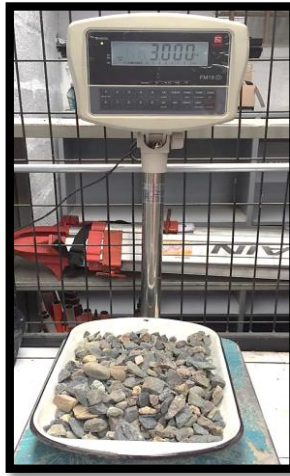
Figura 3.21: Peso seco inicial de la muestra de grava
