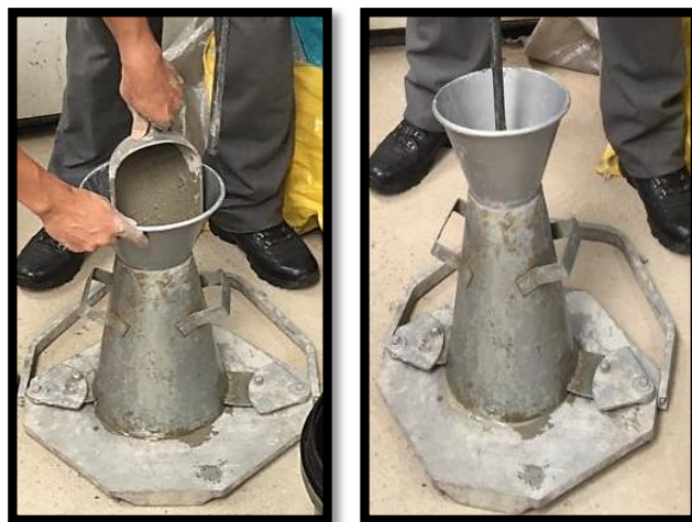
Figura 3.27: Colocación de hormigón en el cono de Abrams
