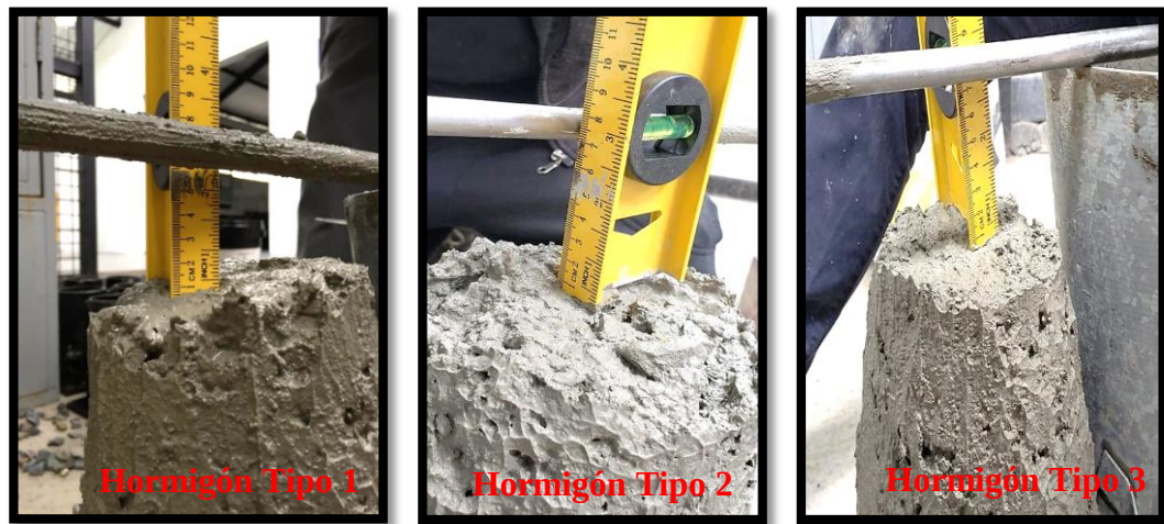
Figura 3.28: Medición de asentamiento de los hormigones
