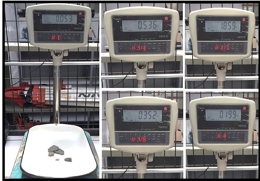
Figura 3.23: Pesos registrados del tamizado de grava
