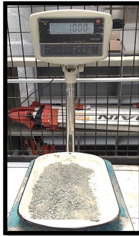
Figura 3.13: Peso inicial de la muestra de Tonalita (cónica)
