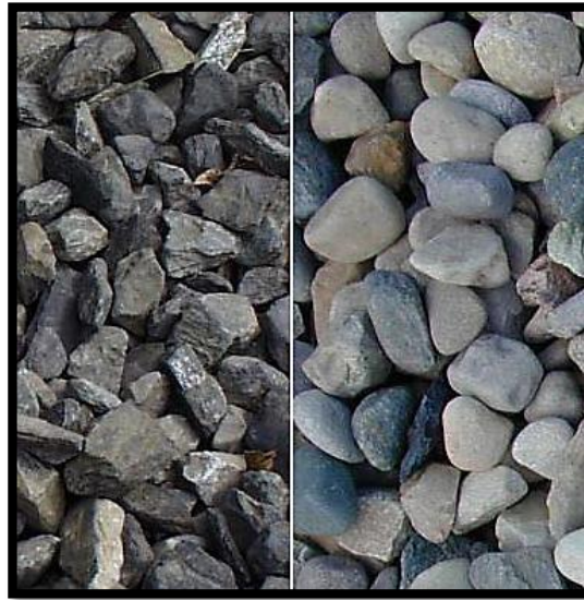
Figura 2.8: Agregado grueso triturado vs Agregado grueso natural
