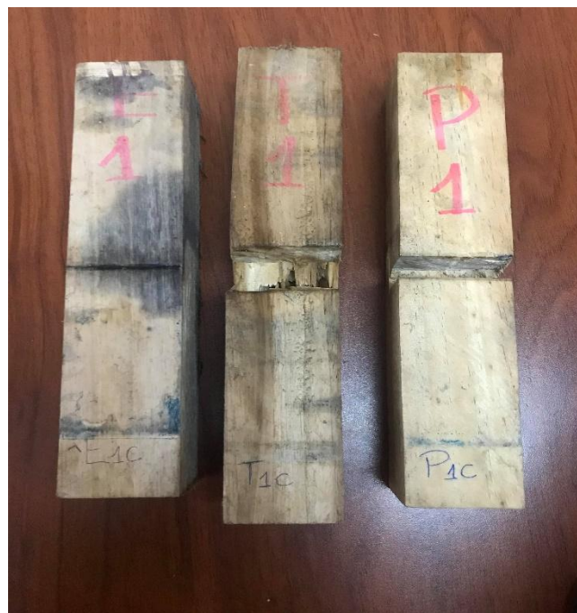
Figura 2.15 Probetas de eucalipto, pino y teca sumergidas 7 días
