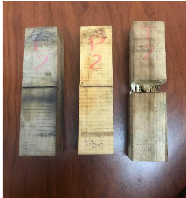
Figura 2.16 Probetas de eucalipto, pino y teca sumergidas 14 días
