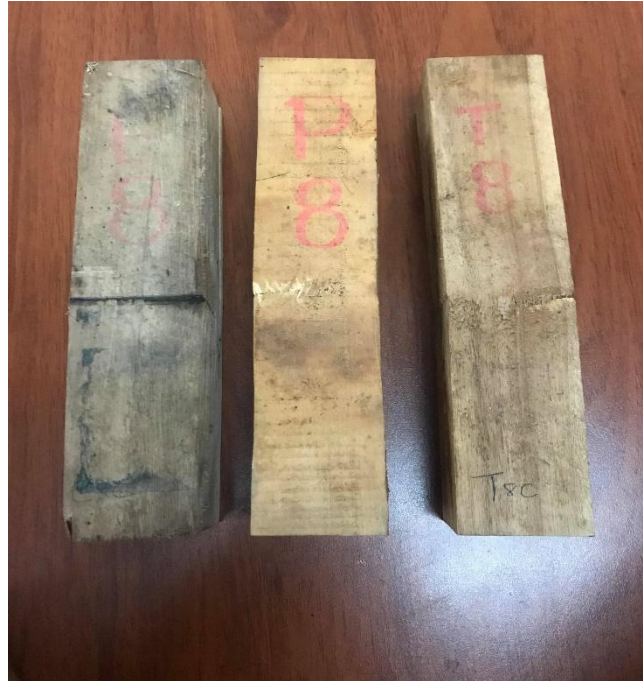
Figura 2.18 Probetas de eucalipto, pino y teca sumergidas 56 días
