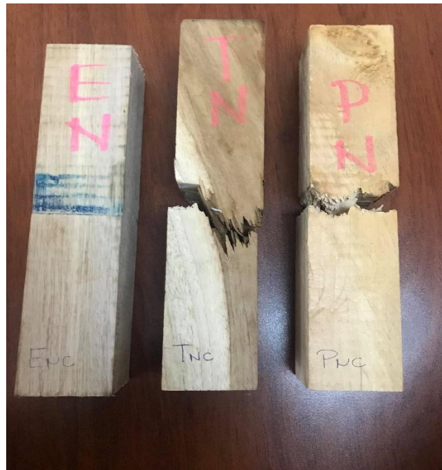
Figura 2.14 Probetas de eucalipto, pino y teca en estado natural
