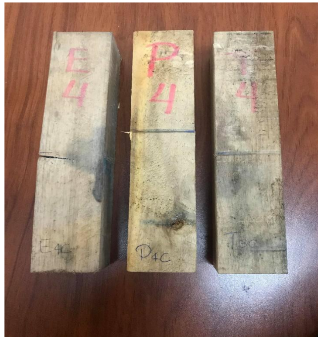
Figura 2.17 Probetas de eucalipto, pino y teca sumergidas 28 días
