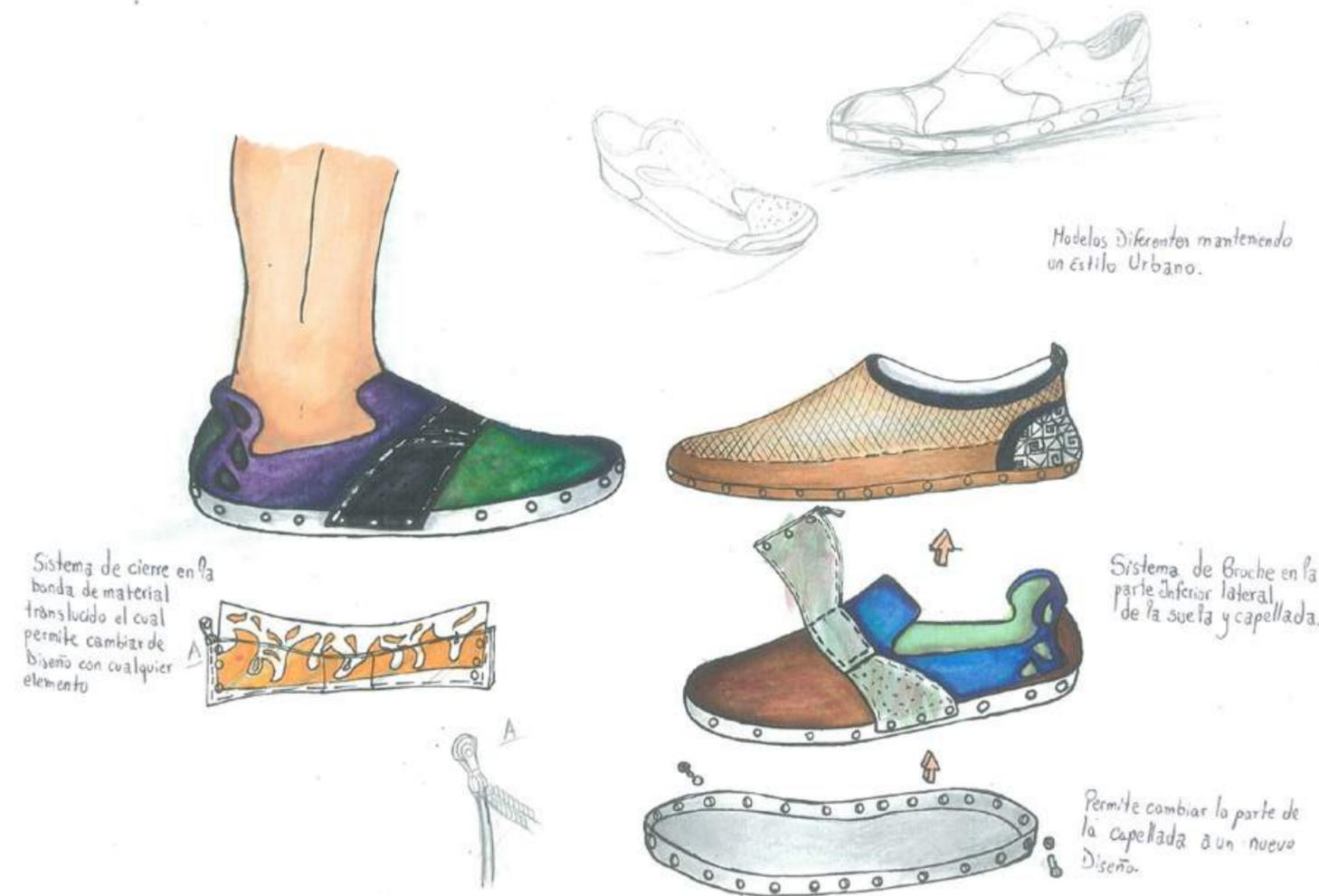
Ilustración 14. Sistema de broche y cremallera adición y sustracción
