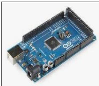
Fig. 28. Arduino MEGA [34].
