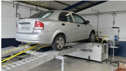
Anexo11a. Disposición de vehículo en dinamómetro
