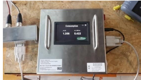
Anexo11b. Pantalla de mando y control de flujómetro
