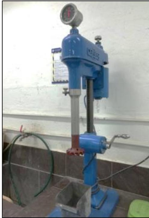
Ilustración 2.5.1 Celda Denver de Laboratorio
