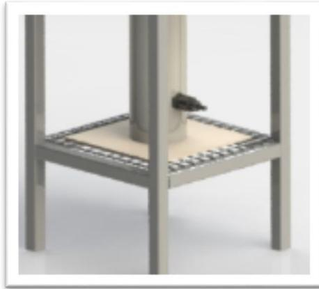
Ilustración 2.5.5 Ingreso de aire comprimido
