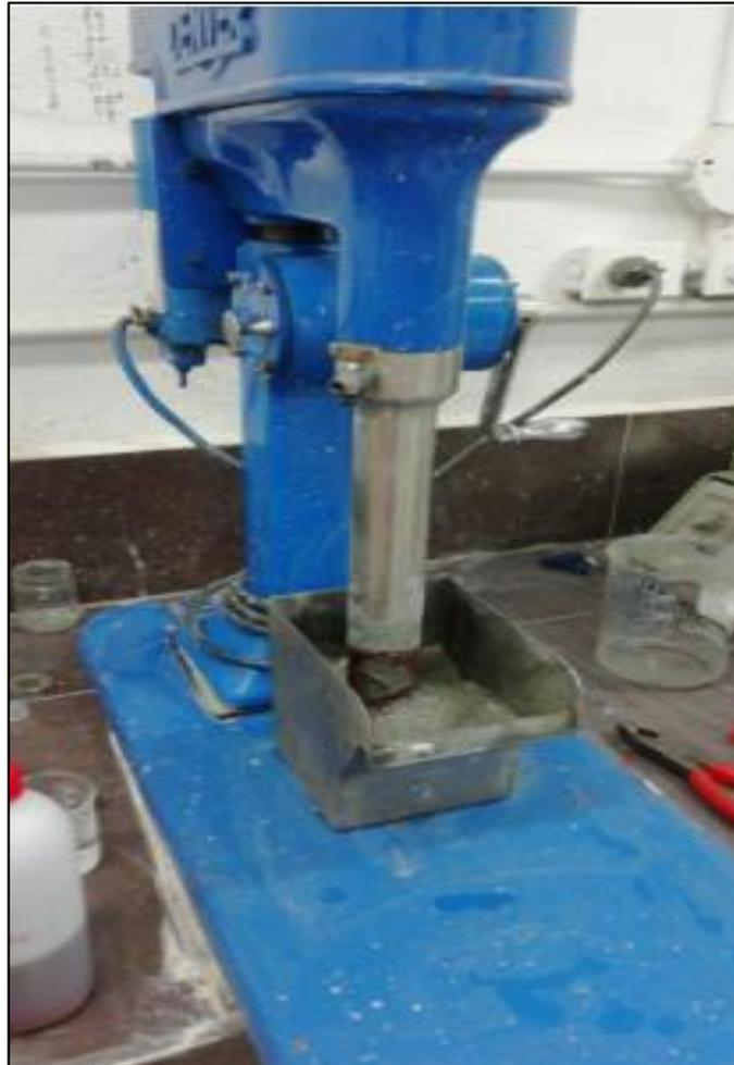
Ilustración 2.5.2 Flotación celda Denver
